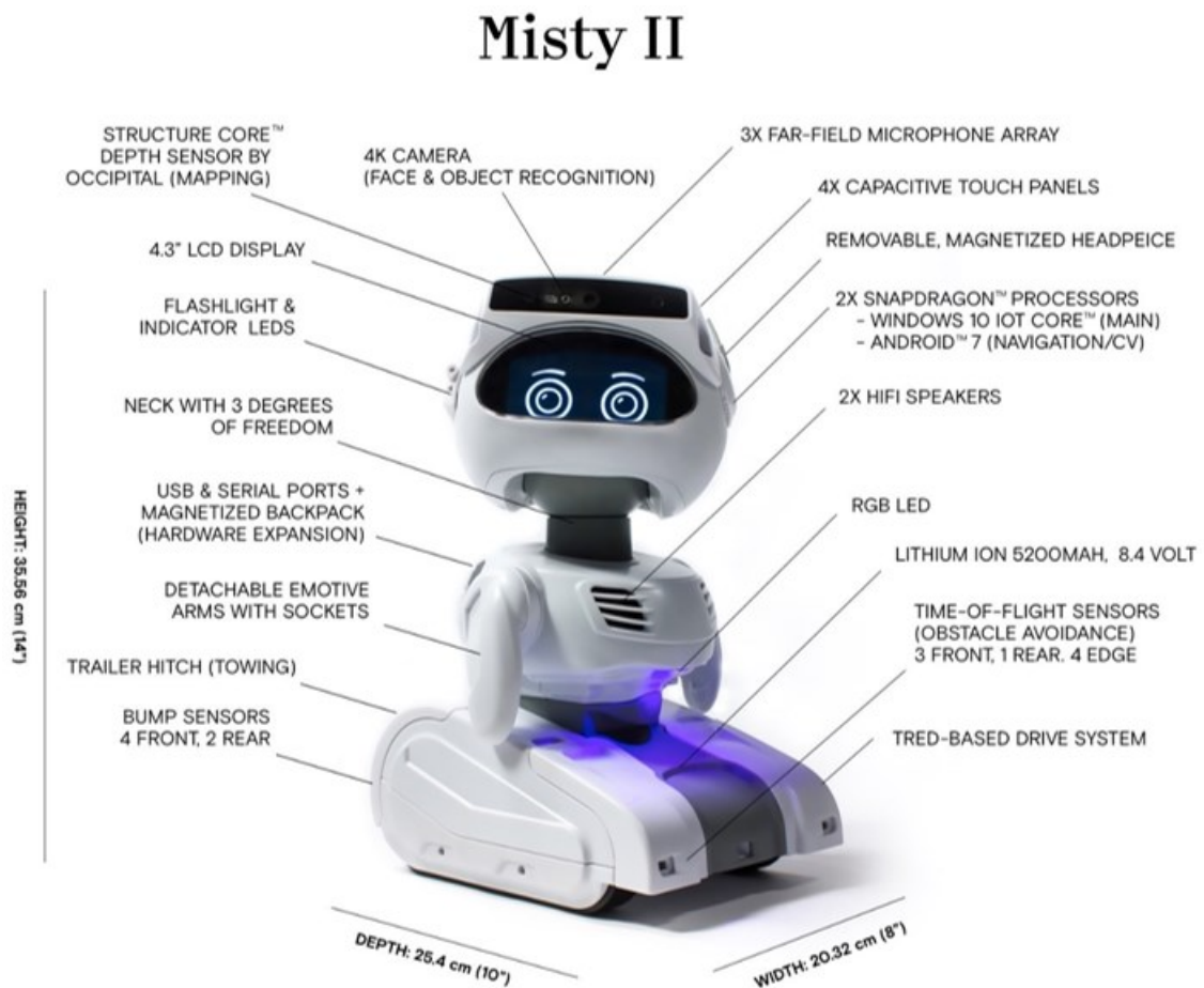
Figura 18: sensori e caratteristiche di Misty II
