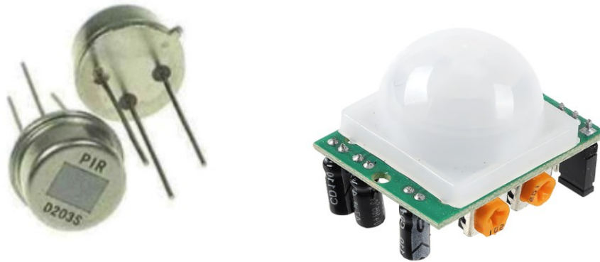
Figura 7: elemento piroelettrico e PIR con lente di Fresnel
