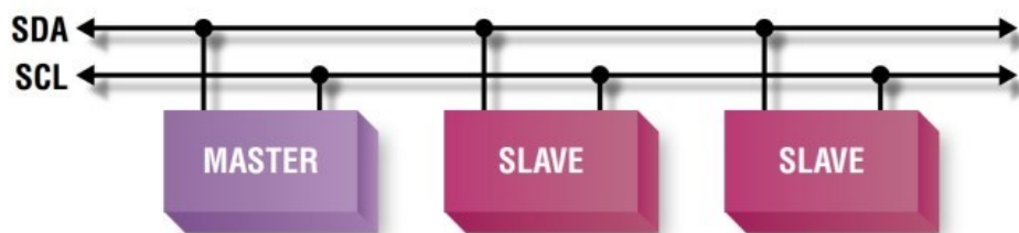
Figura 21: struttura del protocollo I2C
