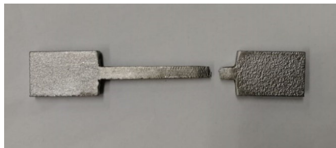
Figura 10 Campione portato a rottura
