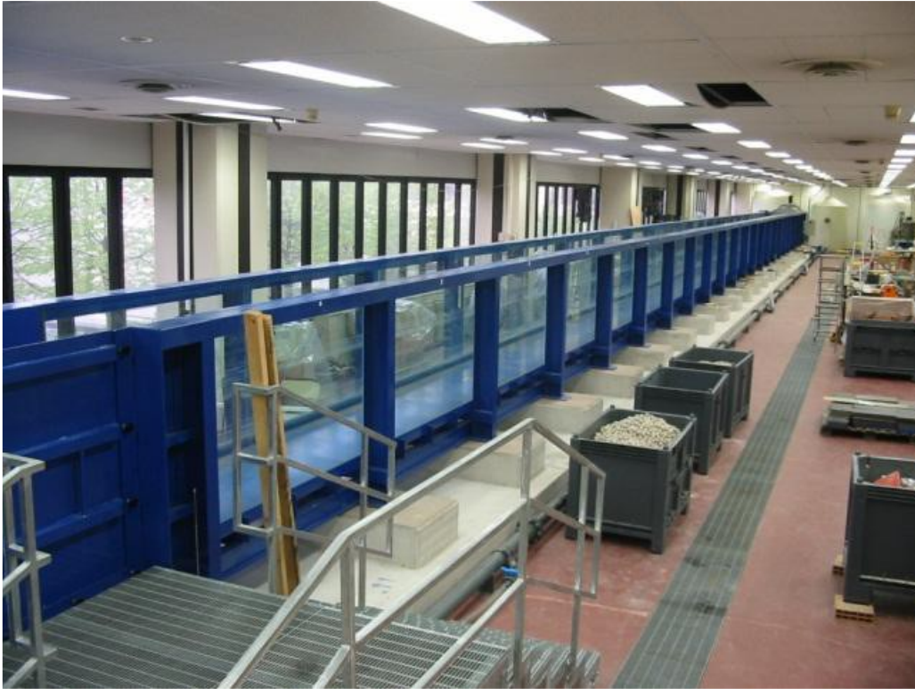
Figura 17 Canale per onde utilizzato nella sperimentazione
