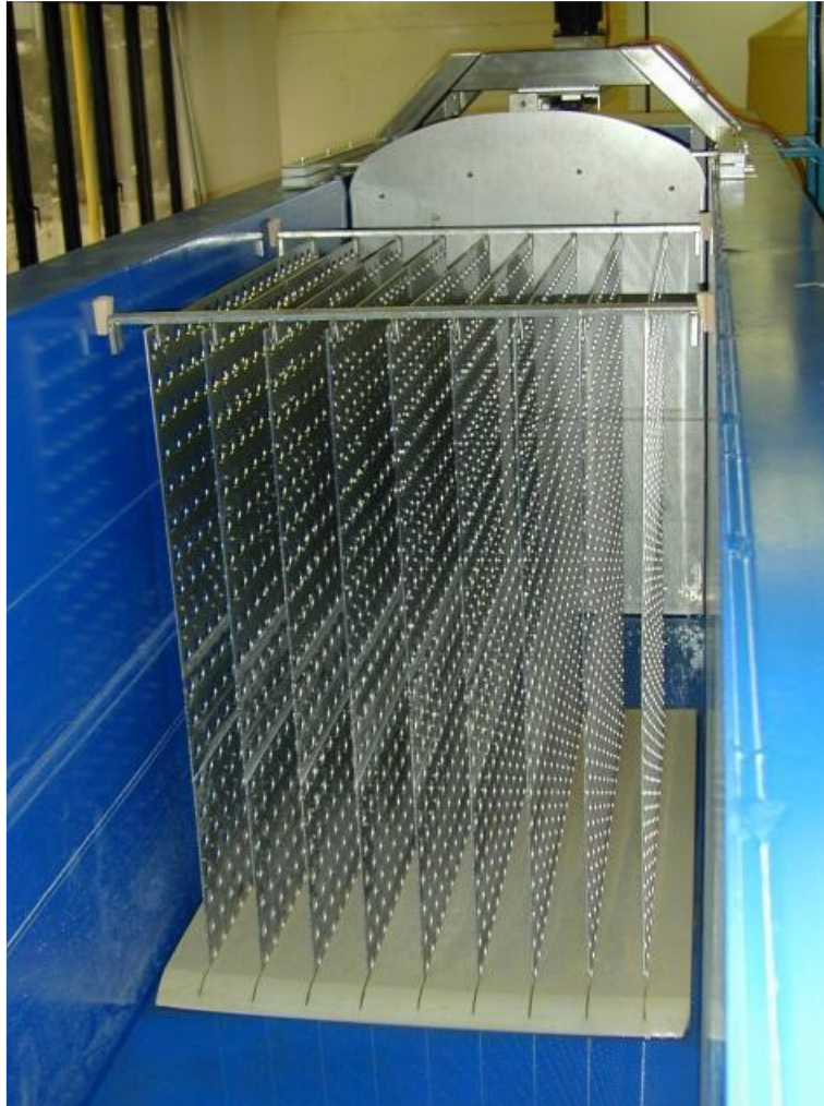
Figura 18 Il generatore d'onda
