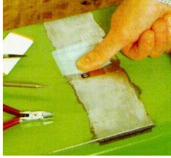
Figura 11 - Fase f dell'incollaggio
