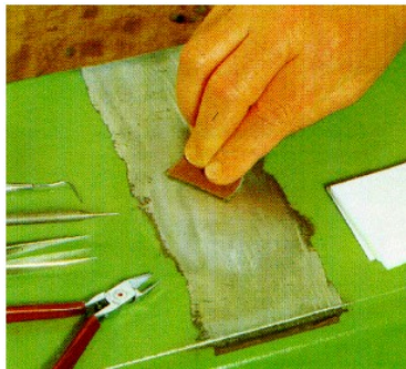
Figura 6 - Fase a dell'incollaggio
