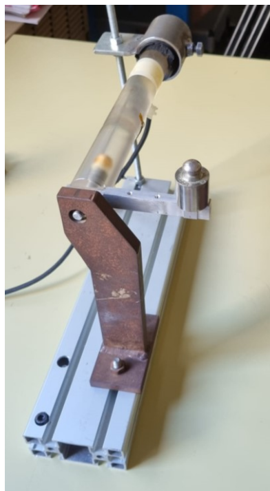
Figura 87 Barra sottoposta a torsione
