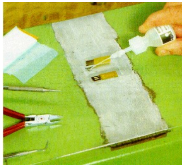
Figura 9 - Fase d dell'incollaggio
