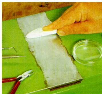
Figura 7 - Fase b dell'incollaggio
