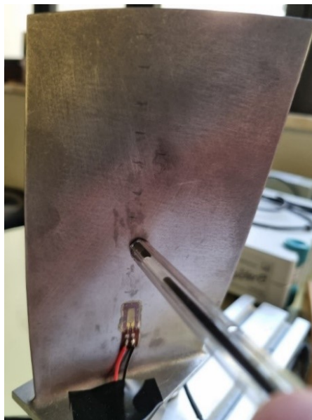
Figura 83 - Tacchette sulla paletta del compressore e sollecitazione con penna
