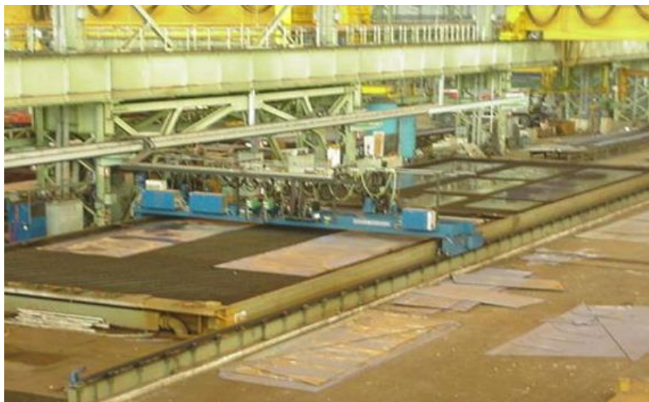
Figura 1.3 Officina di fabbricazione per taglio al plasma
