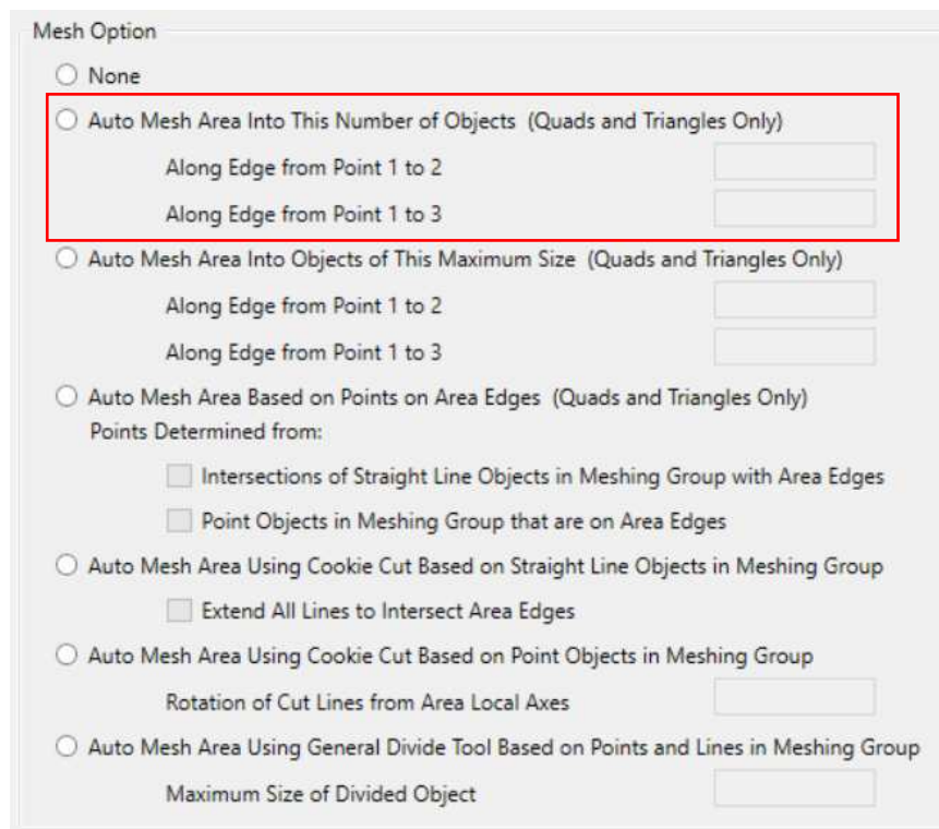
Figura 5.18 Modalità di meshatura automatica scelta
