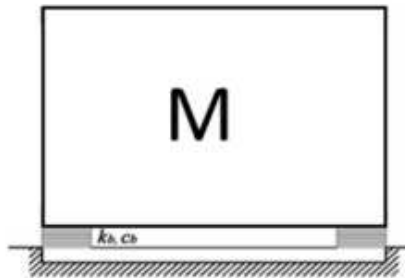
Figura 2.10 Rappresentazione schematica del caso limite di sovrastruttura infinitamente rigida
