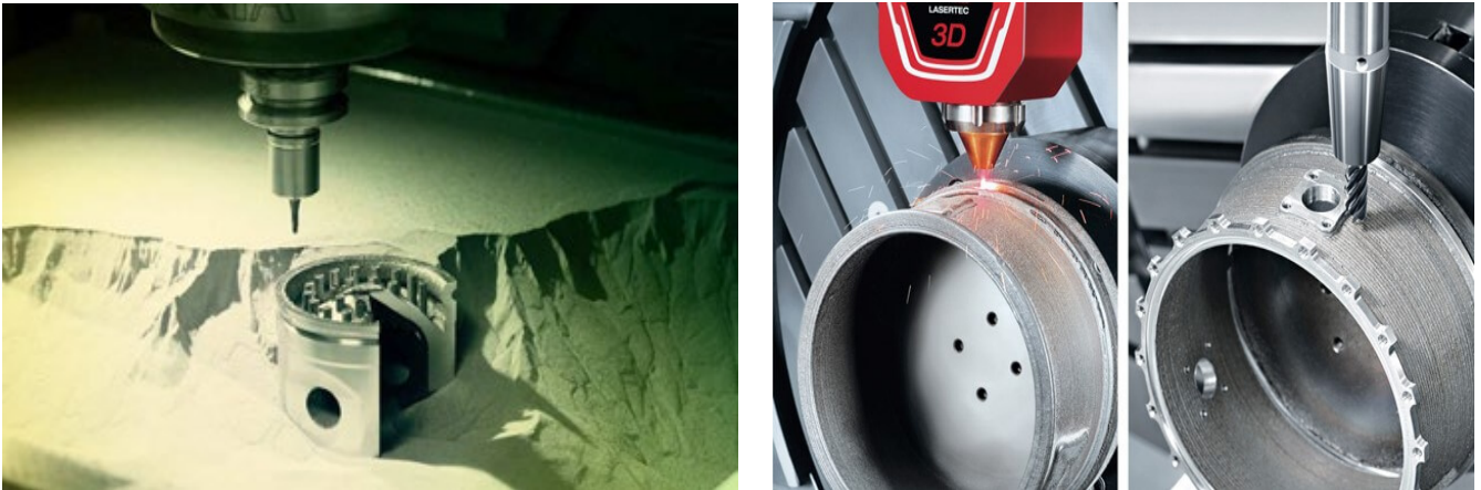
Figura 1.5.1 Rappresentazione della nuova tecnologia dell'Hybrid Manufacturing
