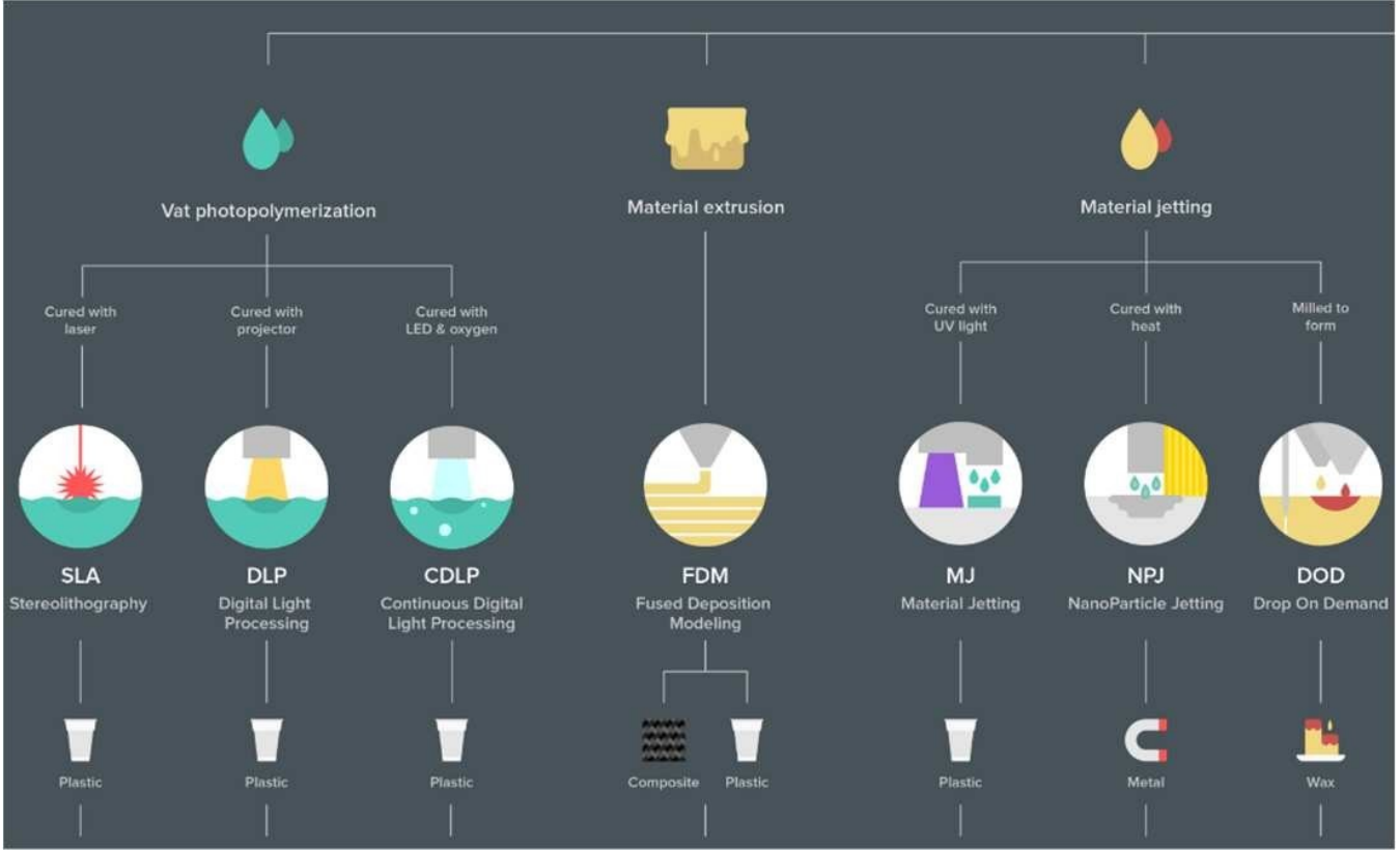
Figura 1.1.2 Dettagli delle varie tecnologie AM
