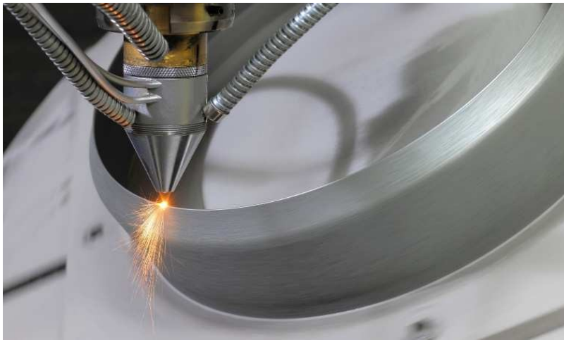
Figura 2.1.1 Rappresentazione della tecnologia Directed Energy Depositi
