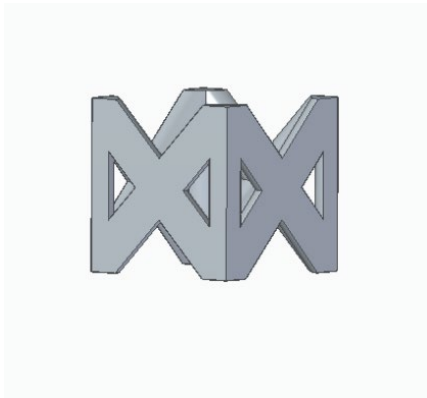
Figura 3.1.1 Cella FCCZ con associati i suoi parametri di costruzione.
