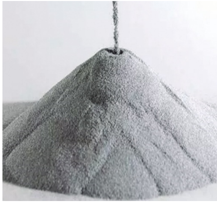
Fig. 2.3.1 Polvere di Inconel 718
