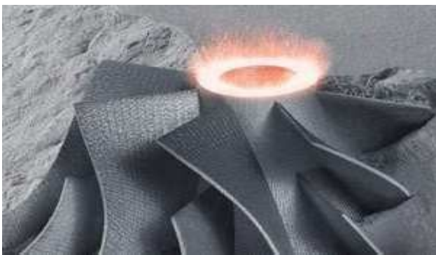
Figura 2.2.1 Rappresentazione della tecnologia Powder Bed Fusion
