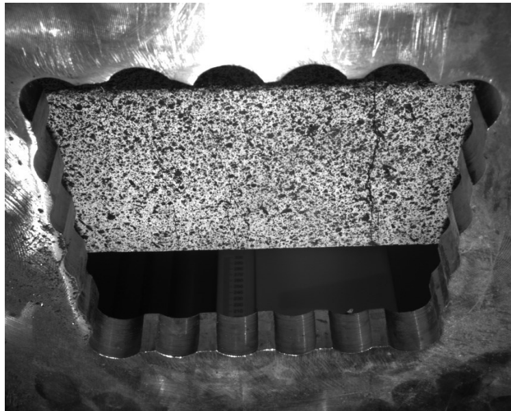
Figura 35 – Inquadratura dal basso durante la prova di carico statica, dettaglio multifessurazione.
