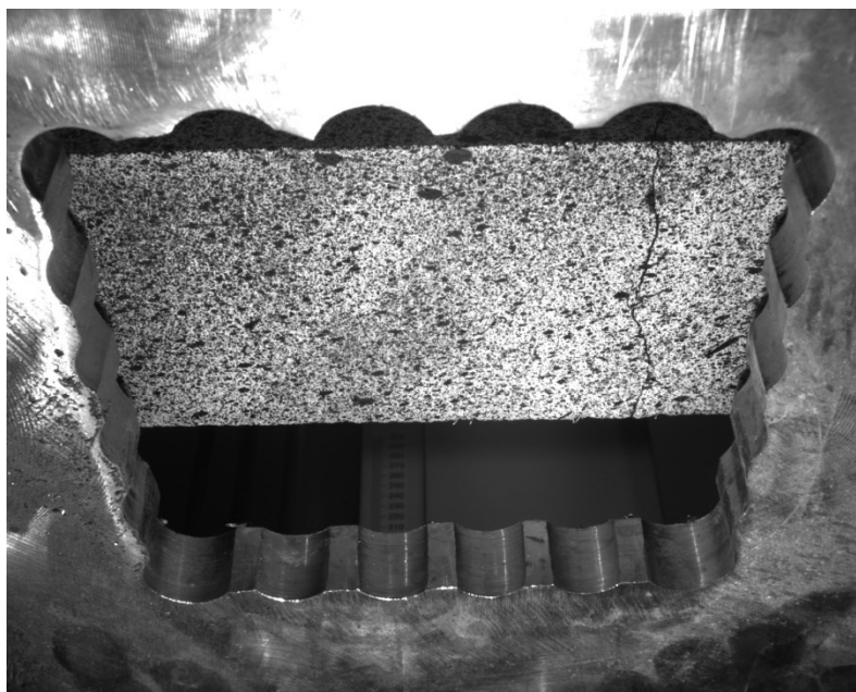
Figura 65 – dettaglio di fessurazione durante il test di flessione ciclico.
