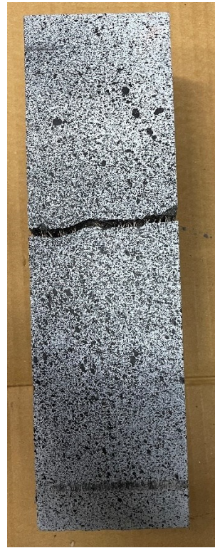
Figura 31 – a) dettaglio fessurazione vista laterale provino A 1% fibre; b) dettaglio fessurazione vista frontale provino B 1% fibre
