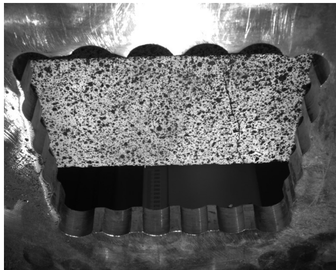
Figura 38 – formazione di singola fessura inquadratura dal basso ravvicinata provino C.
