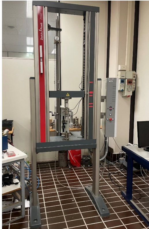
Figura 23 – Macchina Zwick/Roell Z050 utilizzata per la prova di flessione
