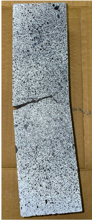
Figura 31 – a) dettaglio fessurazione vista laterale provino A 1% fibre; b) dettaglio fessurazione vista frontale provino B 1% fibre
