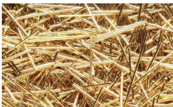
Figura 19 - Fibra in acciaio rivestita di ottone
