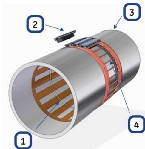
Figura 35 Bobina corpo e le sue componenti: 1) Bobina corpo RM RF; 2) Moduli rilevatore PET; 3) Scudo RM RF; 4) Nervature di supporto.
