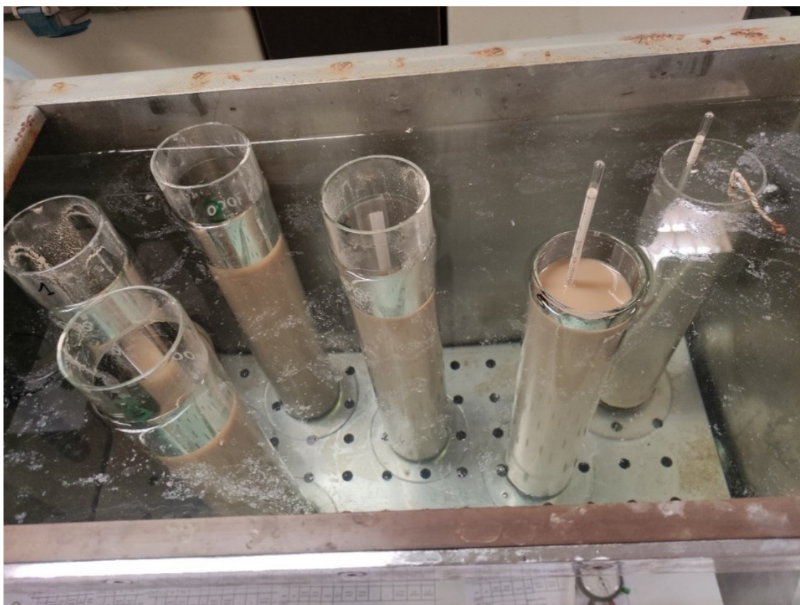
Fig. 2.6.14 Il densimetro viene inserito nei vari cilindri per le misurazioni ad intervalli di tempo
