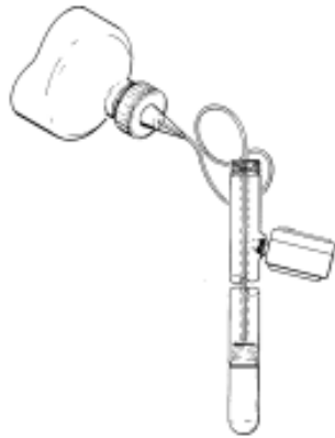
Fig. 2.2.3.3 Il tensiometro durante la fase di riempimento viene mantenuto in posizione verticale (www.soilmoisture.com)
