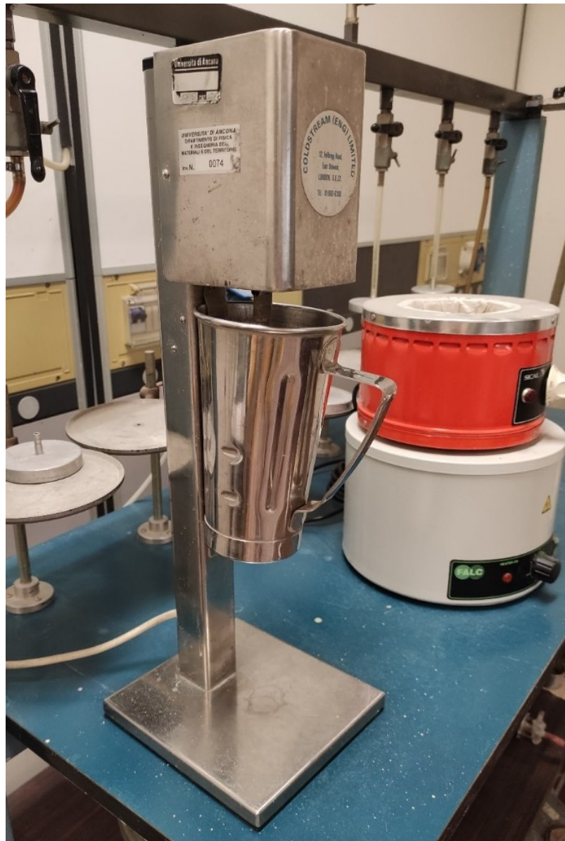
Fig. 2.6.10 Fase di miscelazione con agitatore
