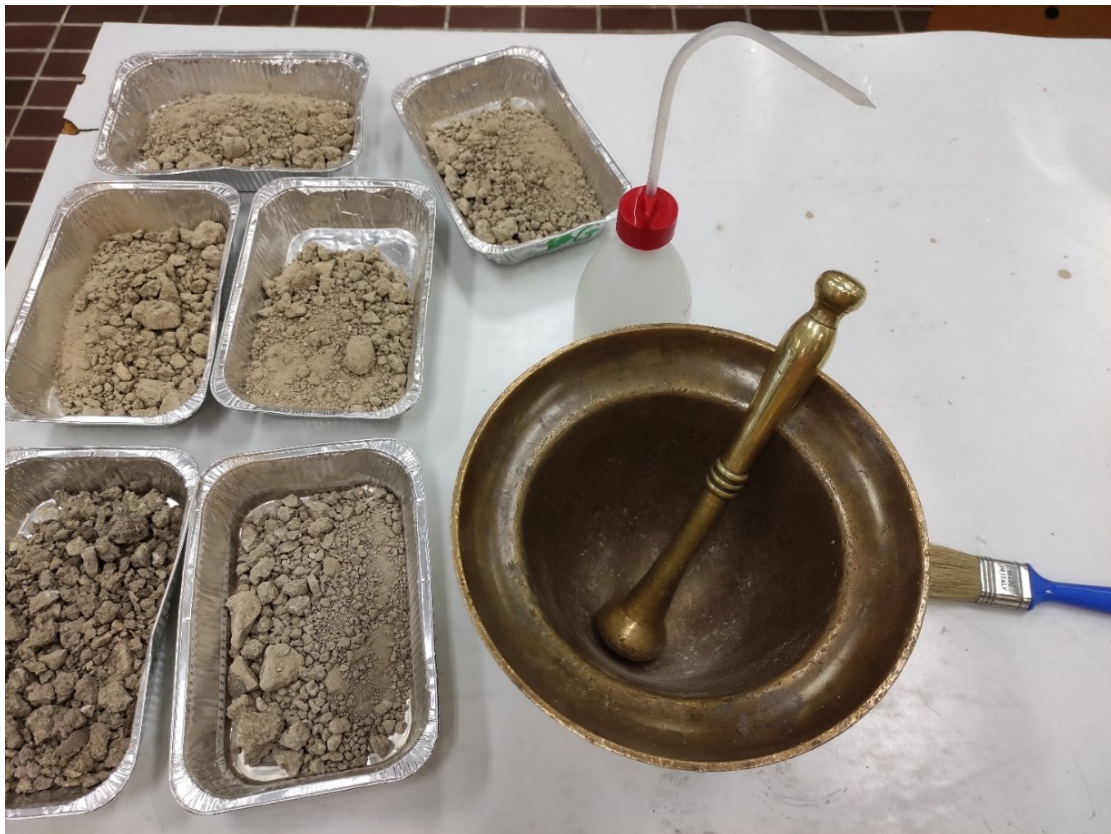
Fig. 2.6.23 Campioni che devono essere sottoposti a frantumazione con mortaio
