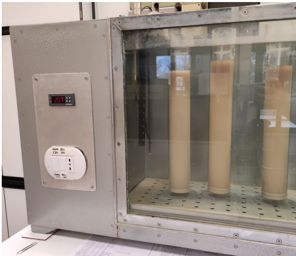
Fig. 2.6.16 Cilindri da giorni disposti nella vasca, si nota materiale sedimentato in basso
