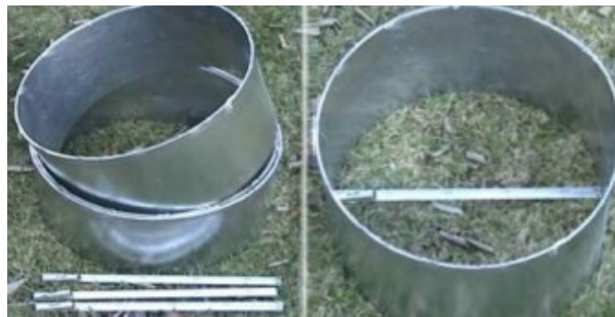
Fig. 2.2.4.1 Infiltrometro a disco o ad anello (www.unirc.it)
