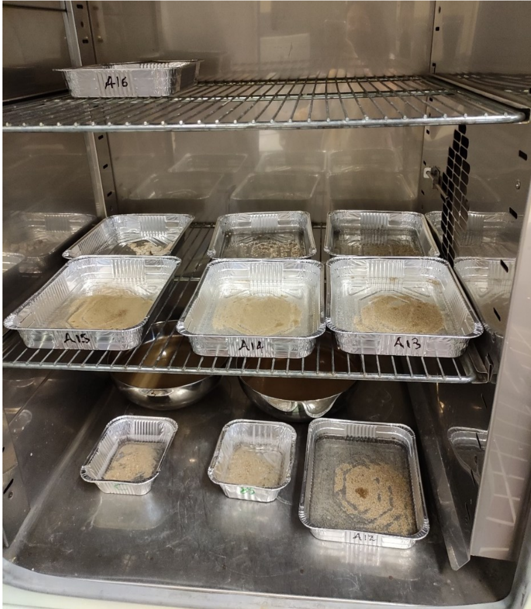
Fig. 2.6.38 Il trattenuto viene fatto essiccare in forno a 105°C
