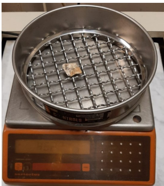
Fig. 2.6.47 Pesatura trattenuto setaccio ASTM n°3/4 in.
