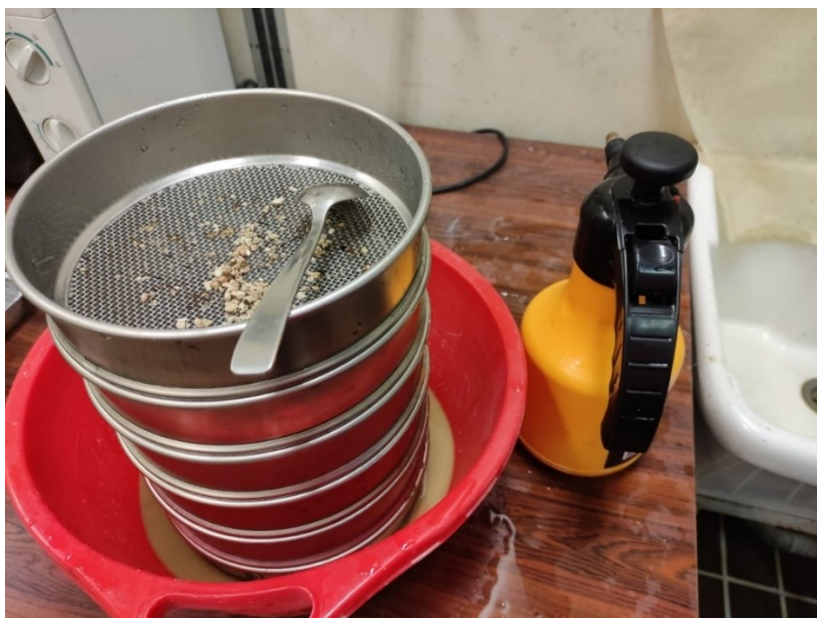
Fig. 2.6.32 Avvio vagliatura ad umido con nebulizzatore della frazione più grossolana
