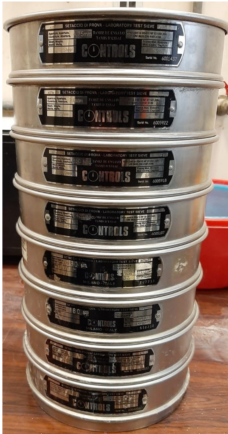
Fig. 2.6.31 Pila di setacci. I setacci sono impilati in ordine decrescente partendo da quelli a maglia più larga fino al setaccio ASTM n°200
