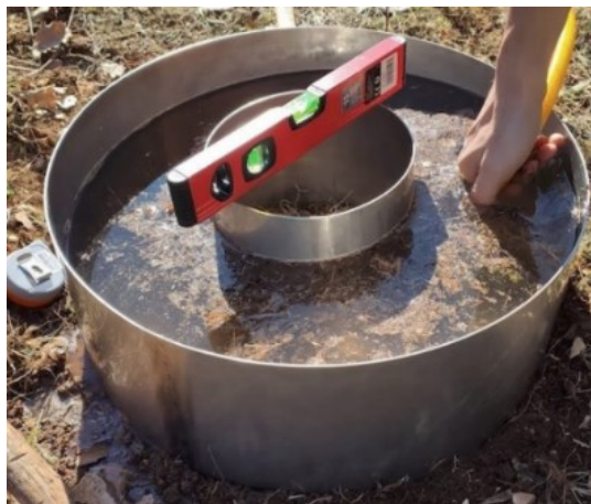
Fig. 2.2.4.1.1 Installazione infiltrometro a doppio anello (www.soilutionsystem.com)
