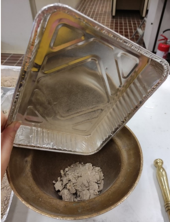
Fig. 2.6.24 Materiale versato nel mortaio per frantumazione
