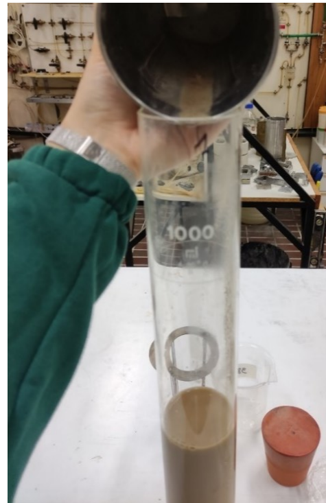
Fig. 2.6.12 Il cilindro riempito fino a 1L viene sigillato con il tappo
