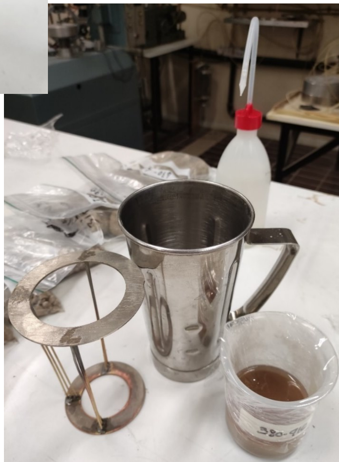
Fig. 2.6.9 Campione lasciato riposare 24h viene versato nel contenitore del frullino
