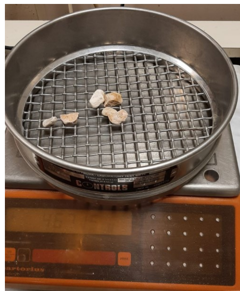
Fig. 2.6.48 Pesatura trattenuto setaccio ASTM n°3/8 in.
