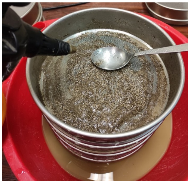
Fig. 2.6.33 Vagliatura ad umido
