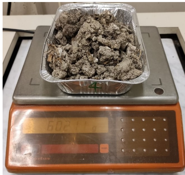
Fig. 2.5.5 Pesatura campione essiccato
