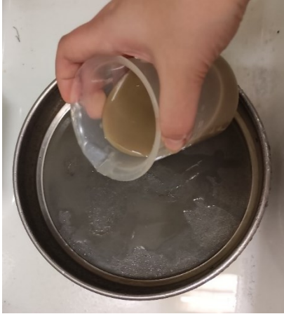
Fig. 2.6.36 Procedura di vagliatura ad umido della frazione più fina con l'ausilio di un becherino
