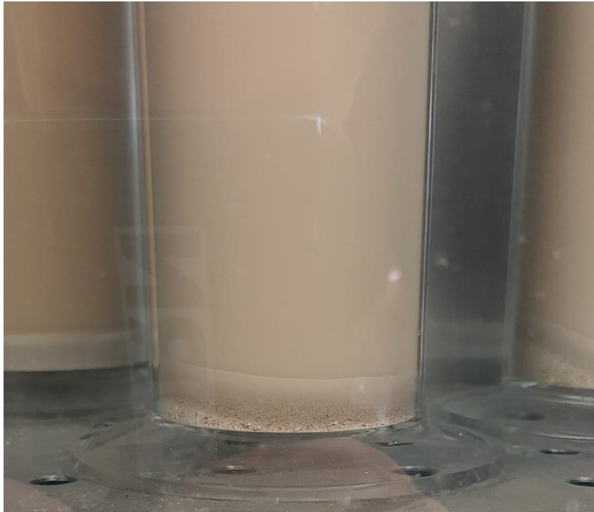
Fig. 2.6.17 Zoom sulla parte bassa del cilindro in cui si nota materiale sedimentato
