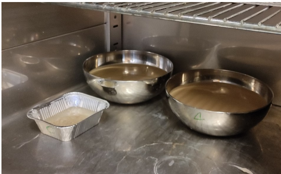
Fig. 2.6.18 Campioni ricavati dall'aerometria messi in forno a 105°C
