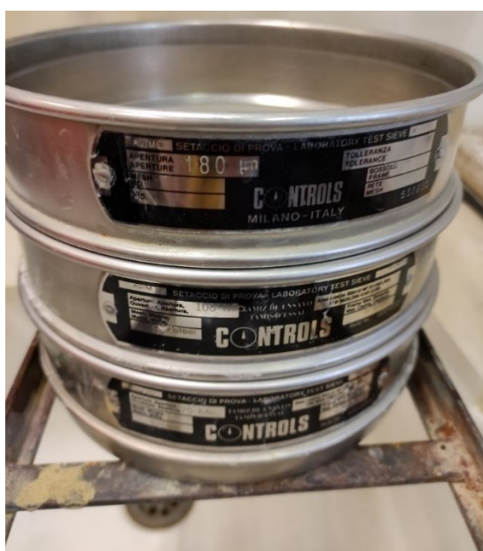
Fig. 2.6.35 Pila setacci ASTM n°80-140-200
