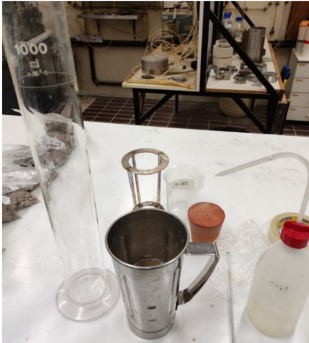
Fig. 2.6.11 Campione miscelato viene versato nel cilindro di vetro
