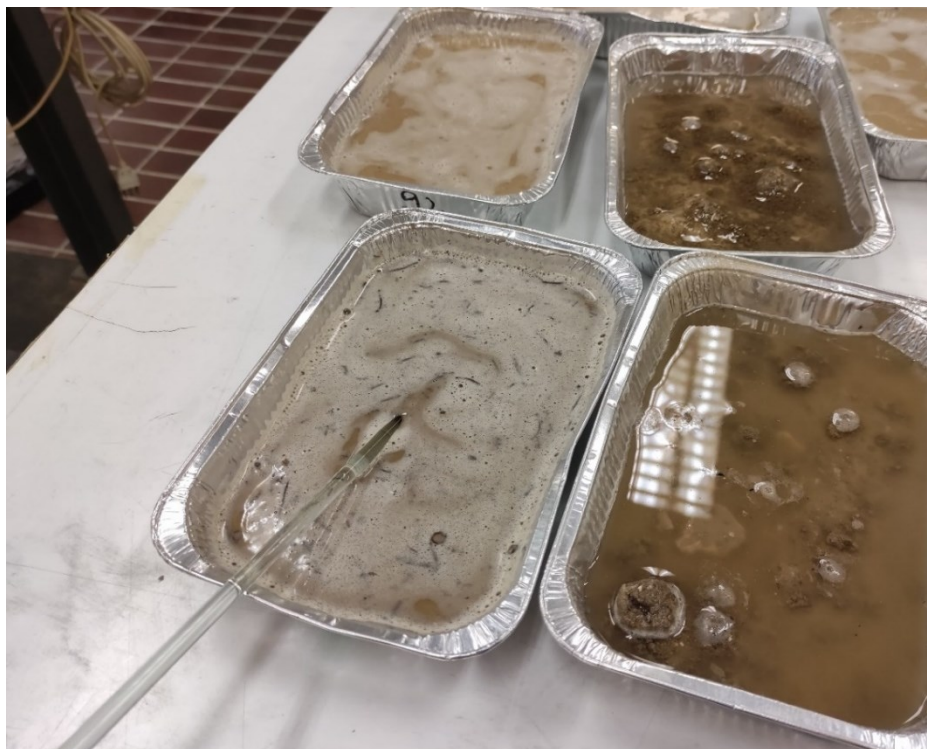
Fig. 2.6.30 Campioni annegati, miscelati e lasciati riposare 24 h
