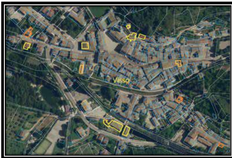
Centro abitato del Comune di Visso. Particolare della mappa catastale con la sovrapposizione dei dati vettoriali, relativi alla tematizzazione dei danni sui fabbricati, scaricata dal Copernicus Emergency Management Service. Fonte: mediageo.it - Il sistema cartografico del Catasto quale strumento di supporto alla gestione delle emergenze
