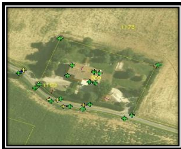
Esempio di punti omologhi con fabbricati e recinzioni (screenshot durante uno step intermedio di applicativi di cartografia)
