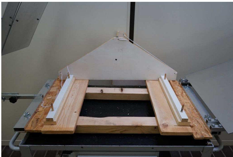
Fig.19: Sistema di supporto in legno
