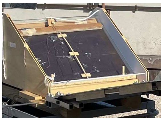
Fig.39: Sostegno in legno per posizionare le termocoppie sulle piastre
