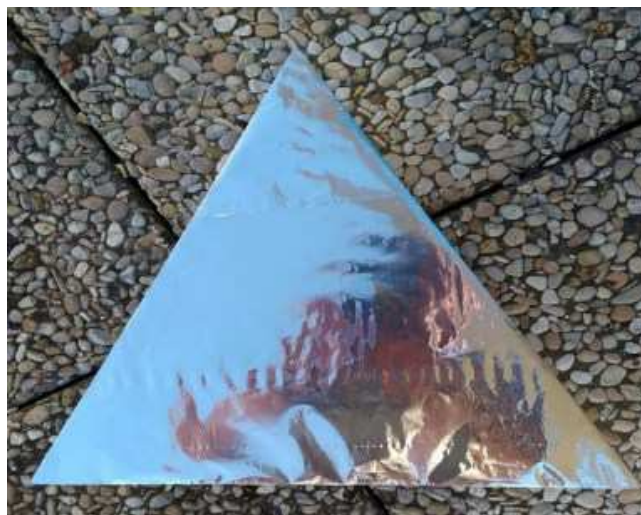
Fig.4: Sportelli laterali triangolari rivestiti con film di alluminio
