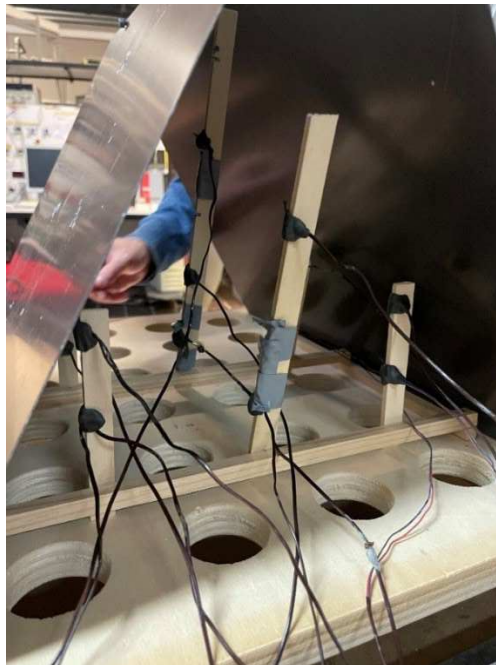
Fig. 59: Configurazione di acquisizione dati all'interno della camera del NSD 1.0
