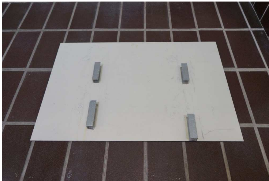
Fig.32: Sistema di ancoraggio degli specchi anteriori
