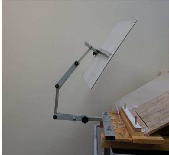
Fig.27: Braccio regolabile a supporto degli specchi posteriori con sistema di fissaggio alla base
