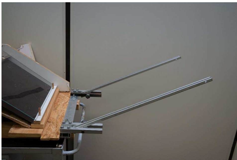
Fig.30: Braccio regolabile a supporto degli specchi anteriori con sistema di fissaggio alla base
