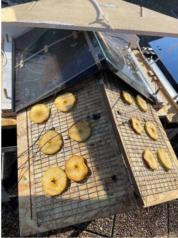
Fig. 66: Sistema di supporto per le mele nella configurazione NSD 2.0
