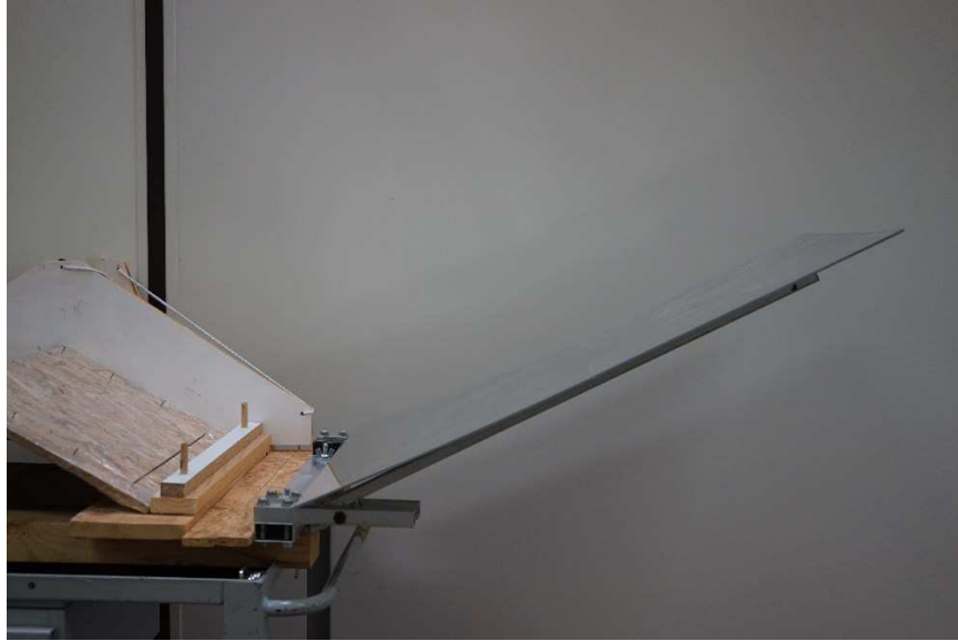
Fig.31: Braccio regolabile a supporto degli specchi anteriori con sistema di fissaggio alla base
