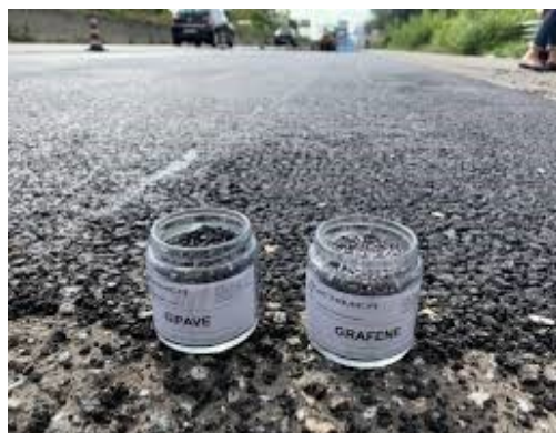
Figura 7 "Pavimentazione stradale realizzata con l'utilizzo di bitume modificato con grafene"
