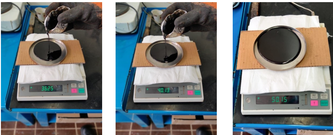
Figura 26 " Dosaggio di bitume con bilancia elettronica"
