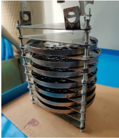
Figura 28 "Provini di bitume con bolle d'aria"
