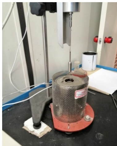
Figura 21 "Gambo e Girante correttamente applicati al rotore"
