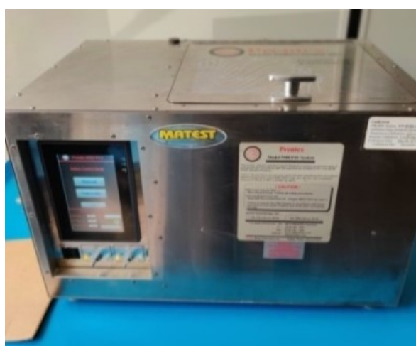
Figura 25 " Forno elettrico in acciaio per PAV"
