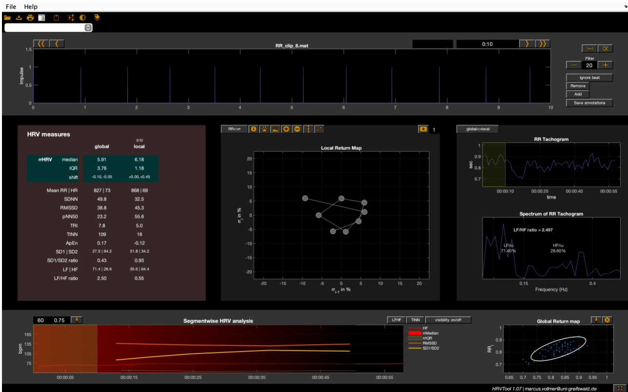
Figura 18: GUI di HRVTool suddivisa in cinque segmenti: (in alto) serie di intervalli RR o forma d'onda con modifica delle annotazioni, (al centro-sinistra) risultati HRV, (al centro) mappa di ritorno del periodo di intervallo RR selezionato con opzione per l'animazione in tempo reale della dinamica dell'intervallo, (al centro-destra) tachogramma dell'intervallo RR e densità spettrale, (in basso) corso temporale dei parametri di HR e HRV e mappa di ritorno dell'intero intervallo interbattito (IBI) con opzione per contrassegnare i valori anomali e per mostrare il relativo periodo degli intervalli RR [32], {7}.
