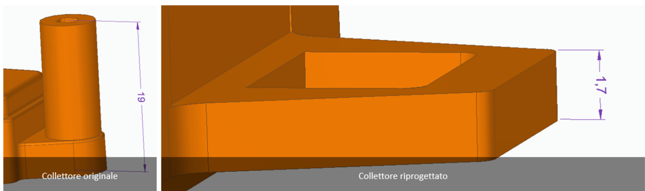
Figura 4.20: confronto tra il tra le due estremità del collettore prima e dopo la riprogettazione
