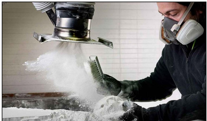
Figura 2.21: rimozione componenti appena stampato in sls
