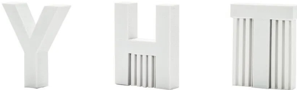
Figura 4.1: esempio di superfici auto supportate (Y) e di superfici non auto supportate (H,T)
