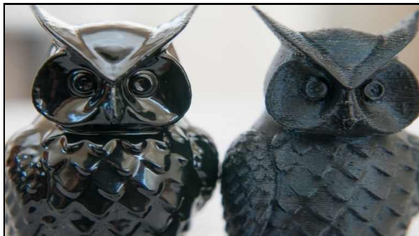
Figura 1.2: esempio di componente trattato (sx) e componente appena stampato (dx)
