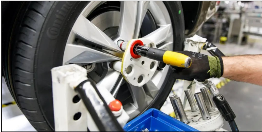
Figura 1.19: maschera di protezione della ruota in stampa 3d. In precedenza, sarebbe costata 800€, ora costa 21€ e con tempi di sviluppo che passano da 56 a soli 10 giorni
