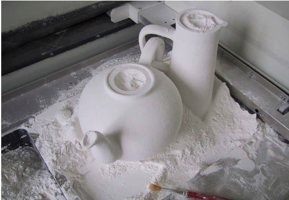
Figura 2.5: processo di eliminazione della polvere dal pezzo stampato
