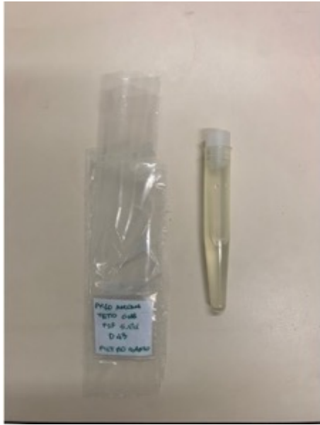
Fig. 27 – provetta in LPDE per stoccaggio del digerito.
