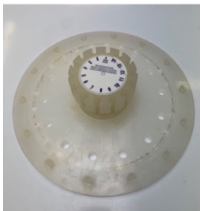
Fig. 24 – carosello per inserire i contenitori.
