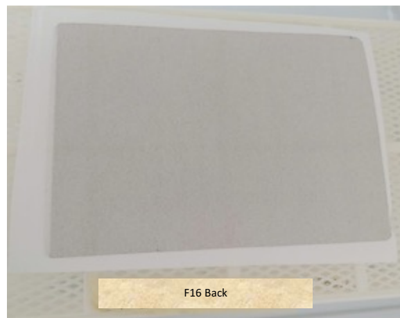
Fig. 20 – Filtri di quarzo campionati da dove sono state prelevate le suddette aliquote.
