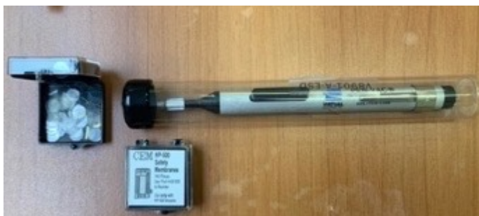
Fig. 23 – ventosa a vuoto per l'applicazione delle membrane.
