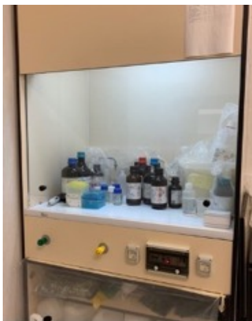
Fig. 22 – cappa chimica della clean room.
