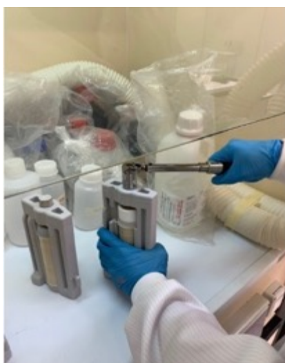
Fig. 26 – fase di chiusura dei contenitori con chiave dinamometrica.
