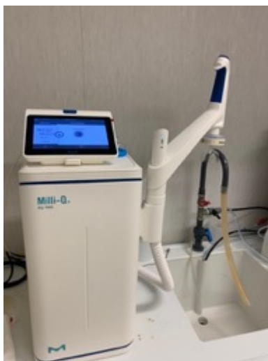
Fig. 16 – Sistema Milli-Q per la produzione ed erogazione di acqua elettro deionizzata
