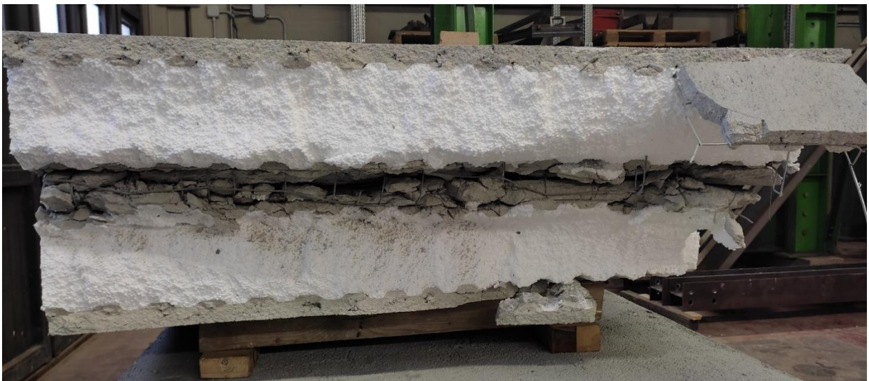
Figura 39 - Rottura per pressoflessione C3
