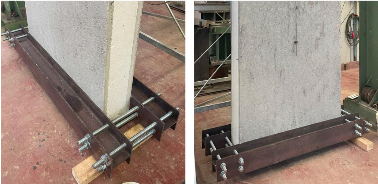
Figura 24 - Profilati metallici in corrispondenza del cordolo inferiore
