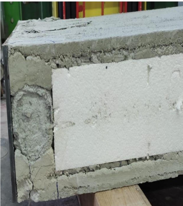
Figura 37 - Rottura per schiacciamento del cordolo superiore C1
