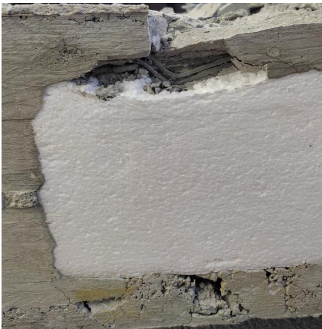
Figura 35 - Rottura per schiacciamento del cordolo inferiore B2
