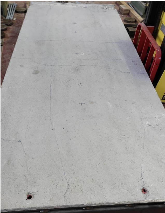
Figura 34 - Rottura per schiacciamento del cordolo inferiore del provino B1
