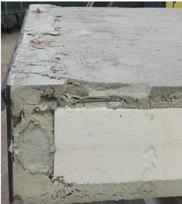
Figura 38 - Rottura per schiacciamento del cordolo superiore C2
