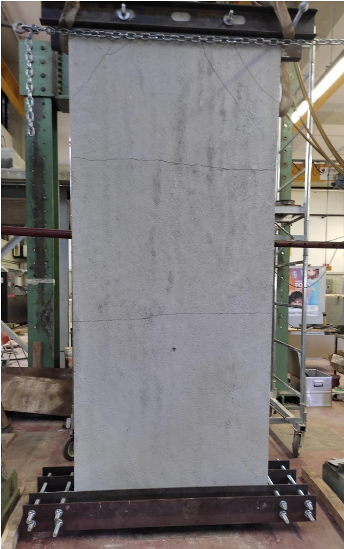
Figura 36 - Rottura per schiacciamento del cordolo superiore B3
