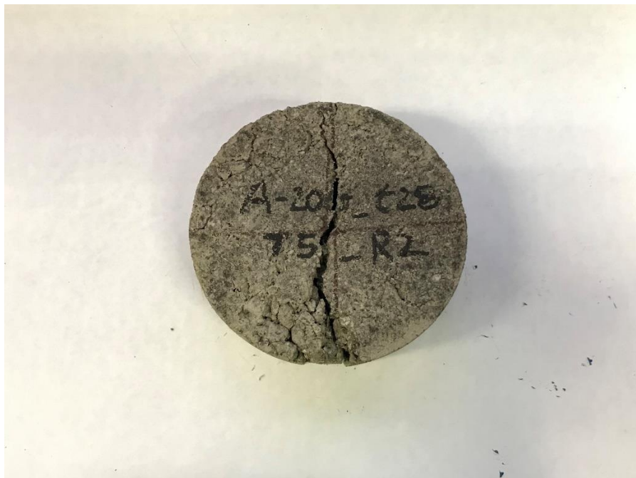
Figura 2.25 Provino dopo aver effettuato la prova di trazione indiretta.
