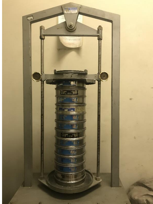
Figura 2.1 Vibrovaglio con fila di setacci pronti per l'agitazione.
