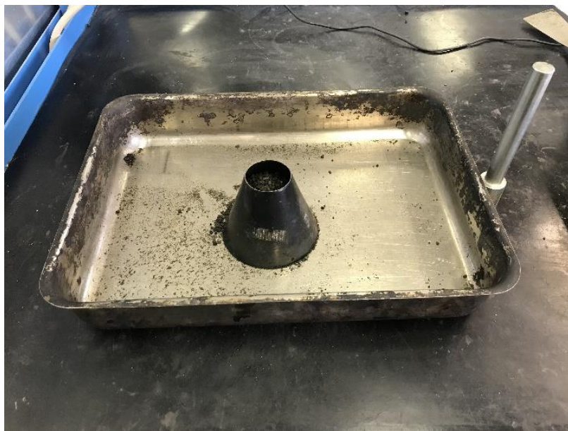
Figura 2.7 Riempimento e costipazione con pestello del tronco di cono metallico.
