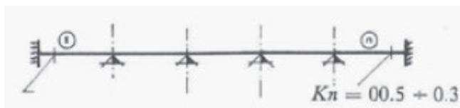
Figura 4.56. Schema di trave continua con incastri elastici di estremità e su appoggi intermedi (PRONTUARIOREP, PROGETTARE CON IL SISTEMA REP: TRAVI REP PILASTRI E SETTI, p. 107).
