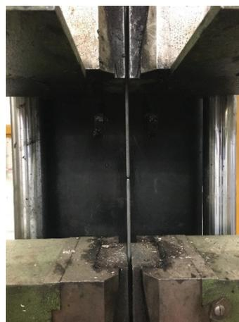
Figura 4.41. A sinistra lo spezzone di armatura  $\phi 6$  estratto, a destra l'esecuzione della prova di trazione.
