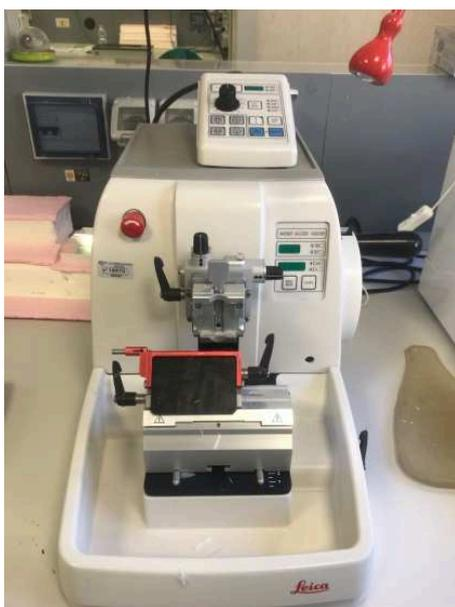
**Figura 14.** Microtomo rotativo Leica RM2255
