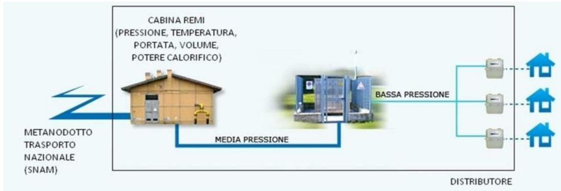
Figura 8: Schema delle varie pressioni di esercizio. [11]
