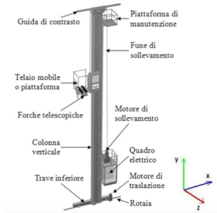
FIGURA 5 STRUTTURA DI UN TRASLOELEVATORE
