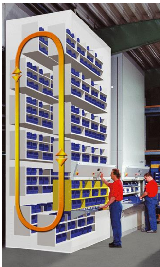
FIGURA 7 MAGAZZINO A CAROSELLO VERTICALE
