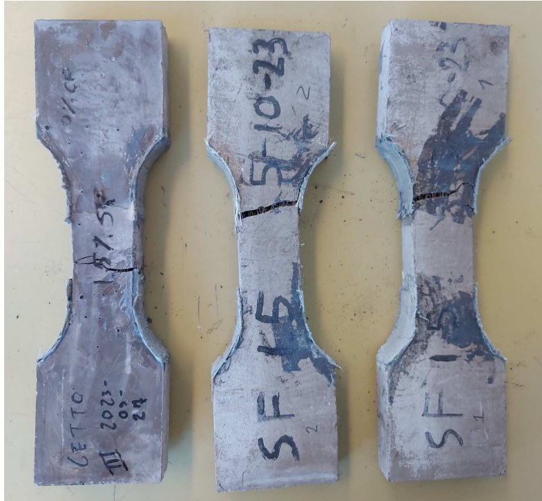
Immagine 52 – Provini della miscela M-1.5 SF a prova ultimata
