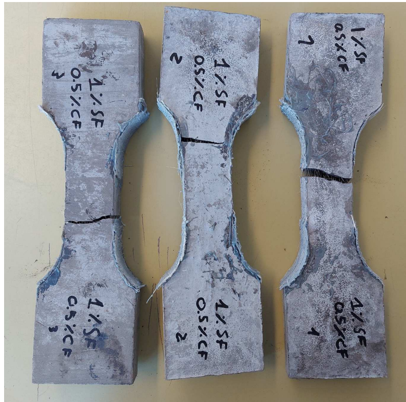
Immagine 56 – Provini della miscela M-1.0 SF 0.5 rCF a prova ultimata
