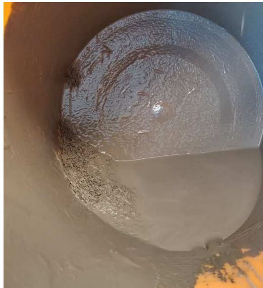
Immagine 17 – Secchio con la miscela della prima prova al suo interno. Da notare il mucchio di fibre metalliche (sx) separato dalla miscela (dx), e la sua elevata fluidità.
