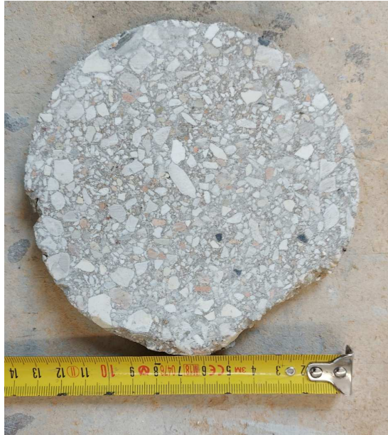
Immagine 13 – Sezione del pilastrino, da notare la buona distribuzione dei componenti
