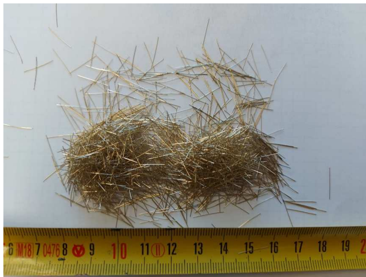
Immagine 10 – Fibre d'acciaio utilizzate nel corso di questa sperimentazione
