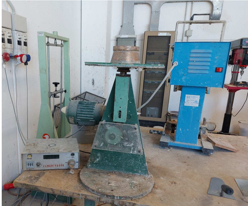
Immagine 25 – Tavola a scosse utilizzata nel corso della sperimentazione per la determinazione della lavorabilità, da notare il recipiente tronco-conico.
