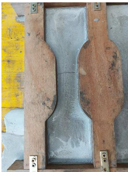
Immagine 18 – Provino “a osso di cane” che si è rotto da solo durante la stagionatura per via dell’elevato ritiro e dell’assenza di fibre.
