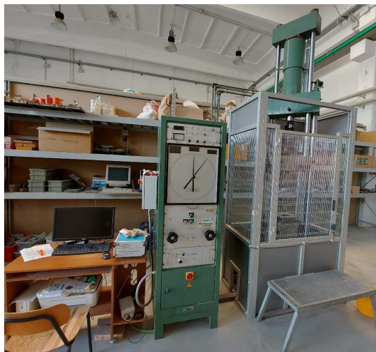
Immagine 22 – Pressa utilizzata nel corso della prova a flessione e a compressione
