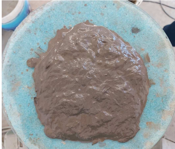
Immagine 20 – Miscela M-1.0 rCF allo stato fresco, visibili i grumi di fibra di carbonio al suo interno e la fluidità non elevata
