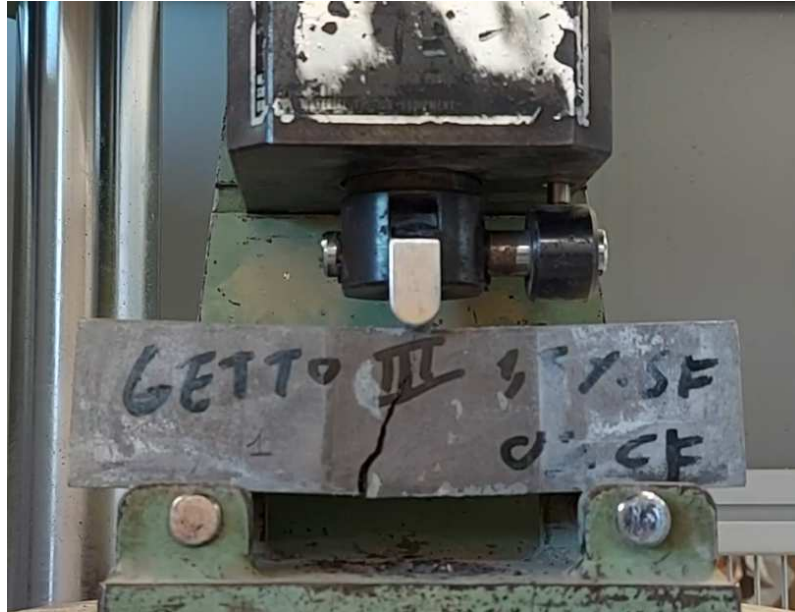
Immagine 33 – Un provino di della miscela M-1.5 SF a prova ultimata
