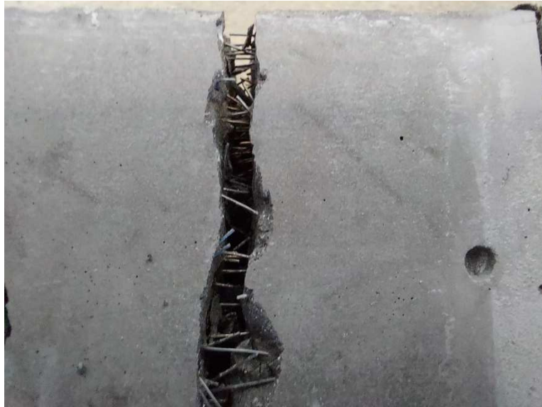
Immagine 9 – Fessura ricucita dalle fibre metalliche
