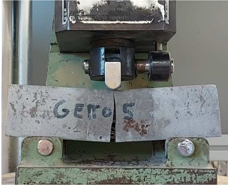
Immagine 37 – Un provino di della miscela M-1.0 SF 0.5 rCF a prova ultimata
