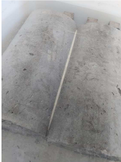
Immagine 16 – Cilindri in calcestruzzo rinforzati durante la maturazione immersi in acqua, da notare il \text{Ca(OH)}_2 che si è depositato tra i due e in sospensione sulla superficie dell’acqua, situazione tipica con gli UHPC che maturano in acqua.
