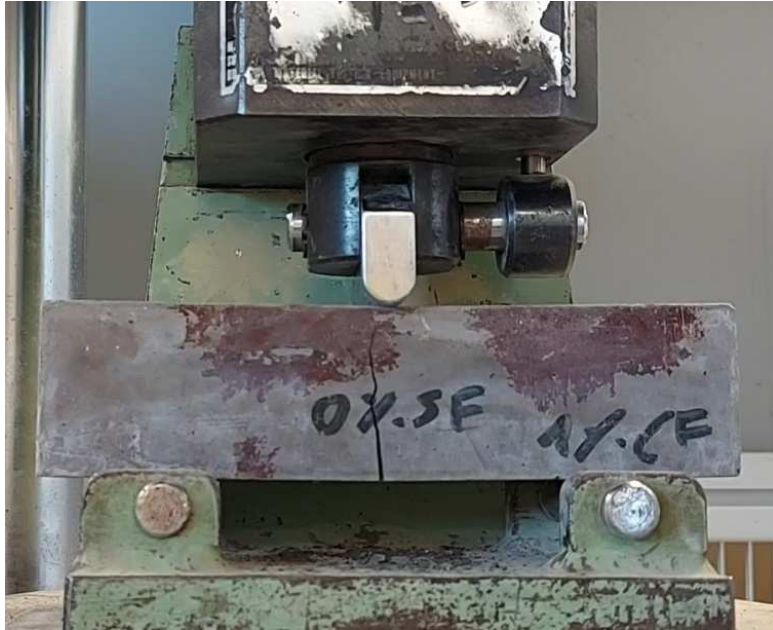
Immagine 35 – Un provino di della miscela M-1.0 rCF a prova ultimata
