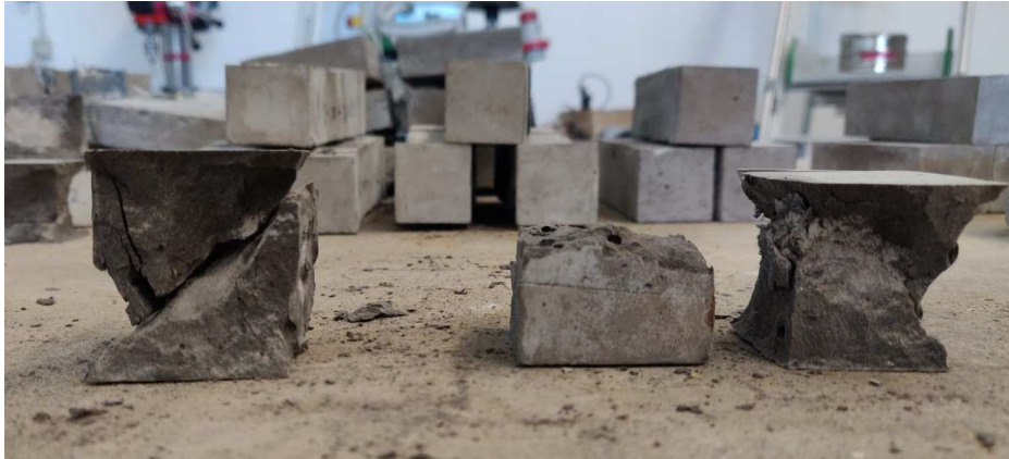
Immagine 23 – Esempio di due estremità di un provino 4*4*16 già rotto a flessione rotte a compressione, da notare la forma a clessidra indice di una rottura corretta.
