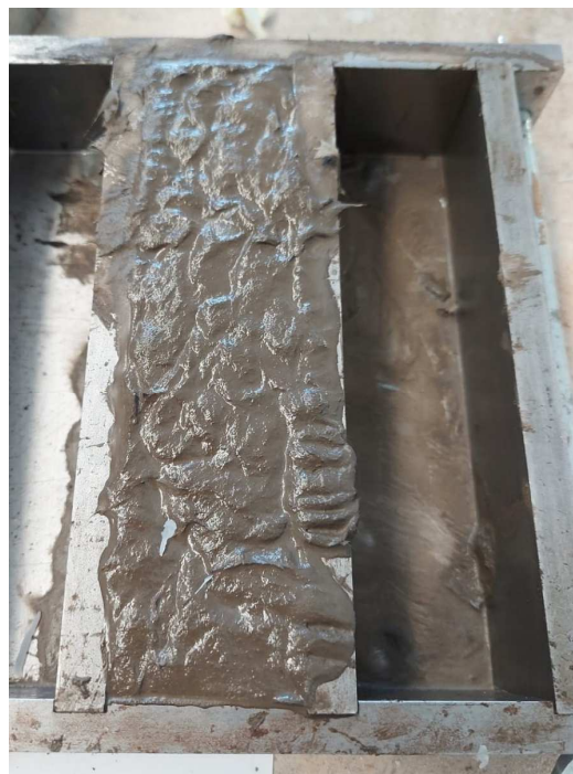
Immagine 11 – Rilascio di acqua da parte della fibra di carbonio, defluita verso il cassero vuoto a dx
