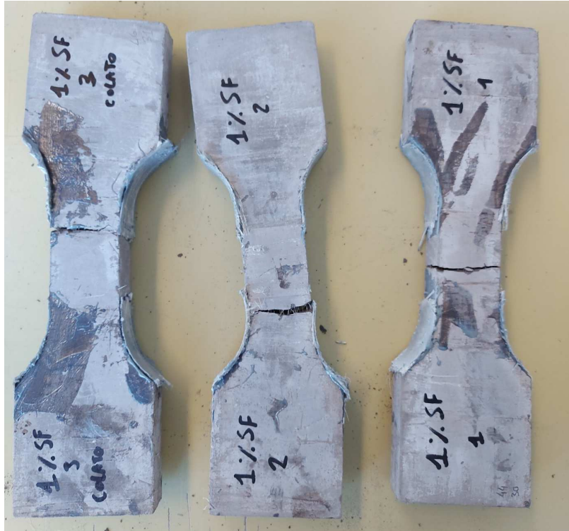
Immagine 50 – Provini della miscela M-1.0 SF a prova ultimata
