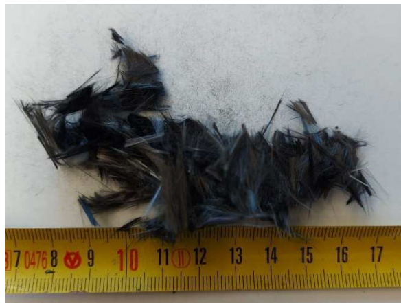
Immagine 12 – Fibra di carbonio utilizzata in questa sperimentazione
