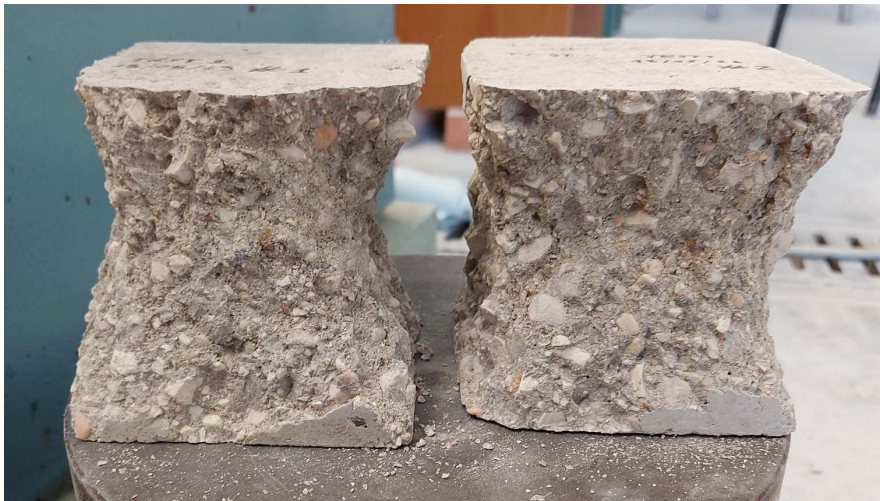
Immagine 14 – Aspetto dei provini dopo la prova di rottura a compressione, da notare la forma a clessidra
