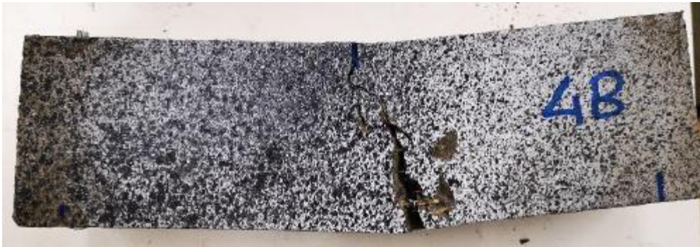
Rottura provini ,CONTENUTO DI FIBRE 100
