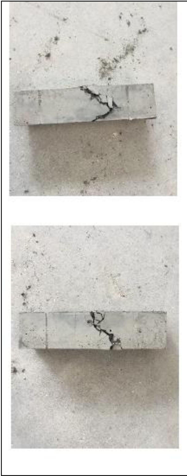
Rottura provino, Contenuto di fibre 150
