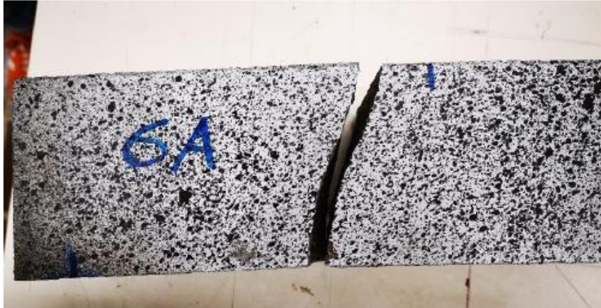
Rottura provini ,SENZA FIBRE
