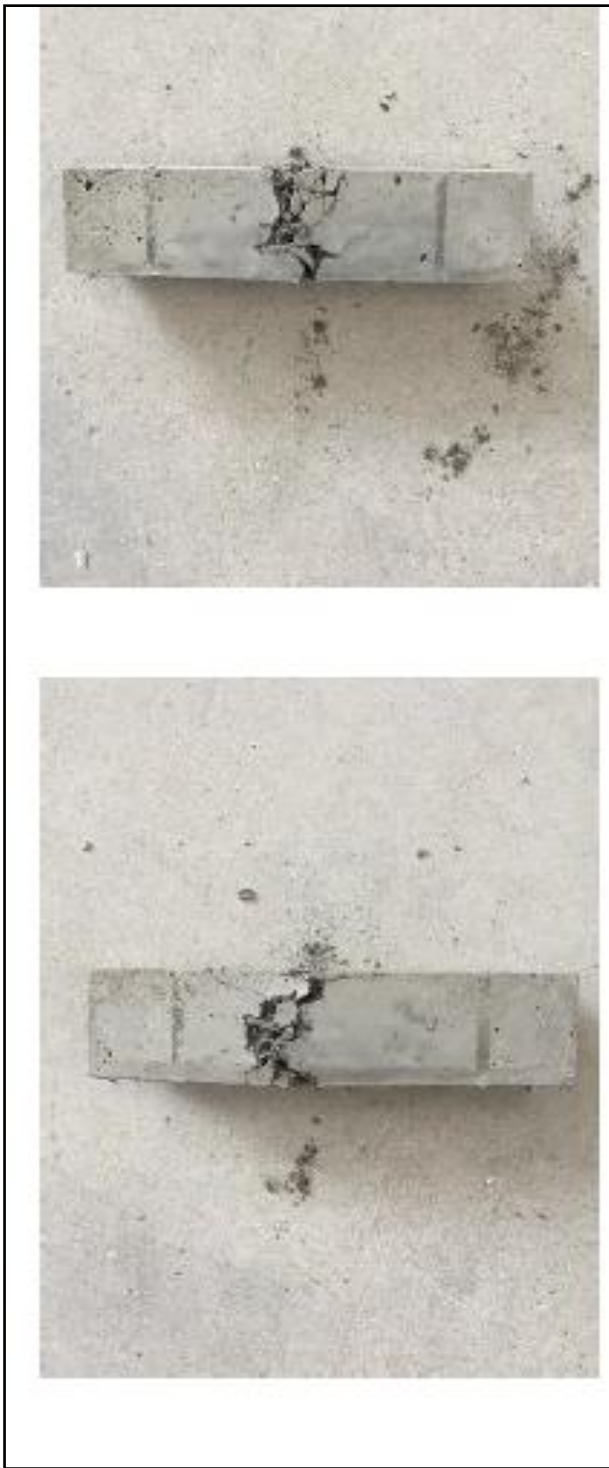
Rottura provino, Contenuto di fibre 200
