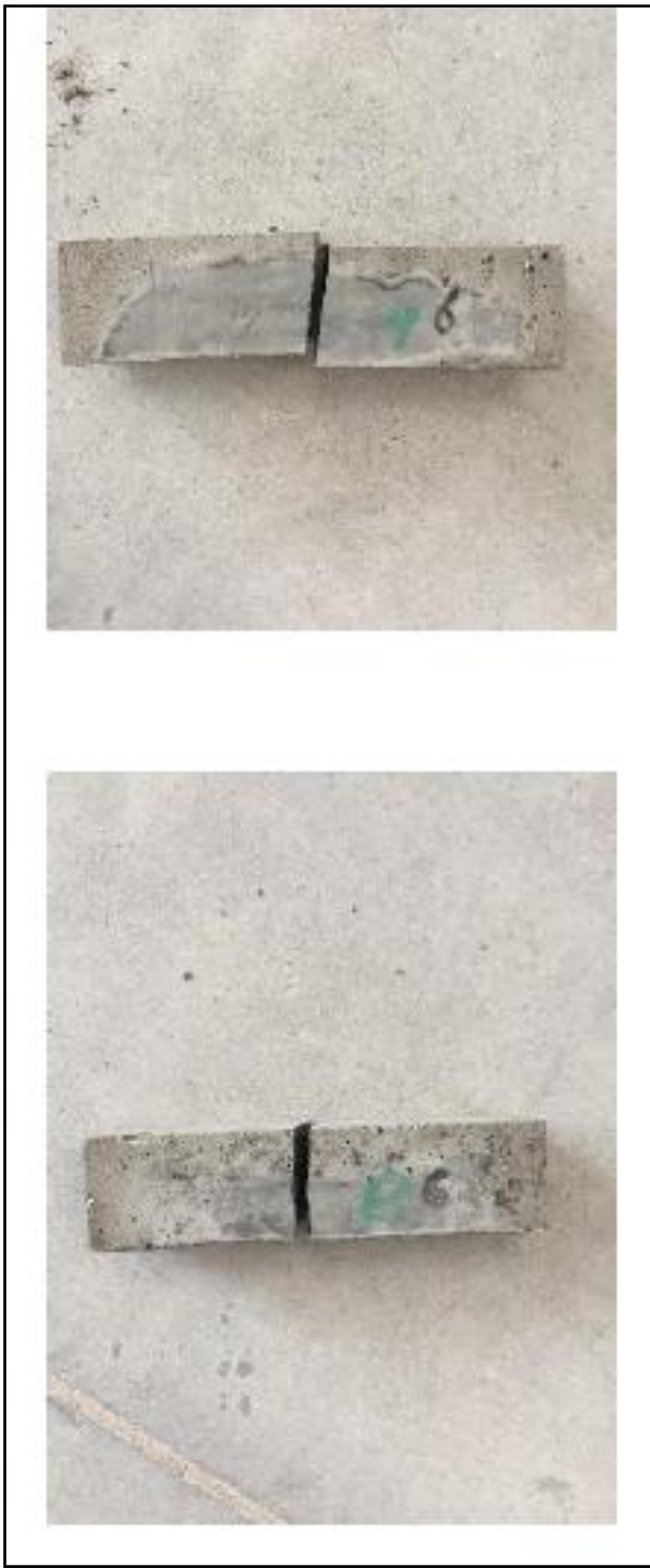
Rottura provino, senza fibre
