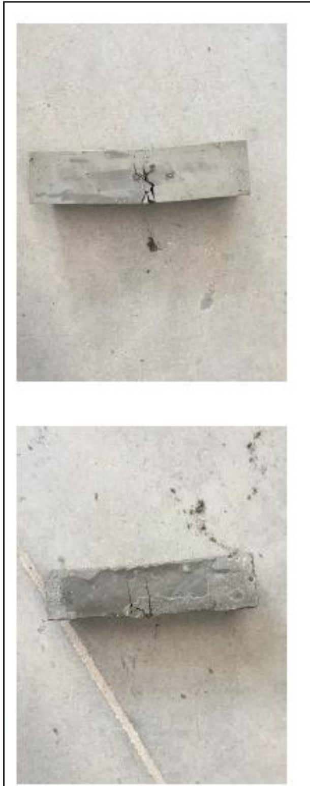
Rottura provino, contenuto di fibre 50
