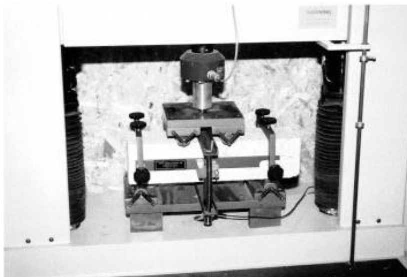
Figura 2.26. Fotografia del macchinario di prova di carico su quattro punti. [ASTM C 1018-97]
