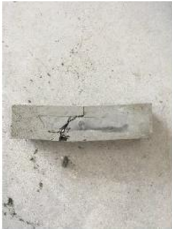
Rottura provino, Contenuto di fibre 100
