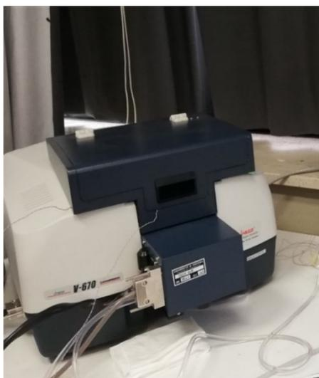
Figura 13 – Spettrofotometro Jasco v670 per la trasmissione
