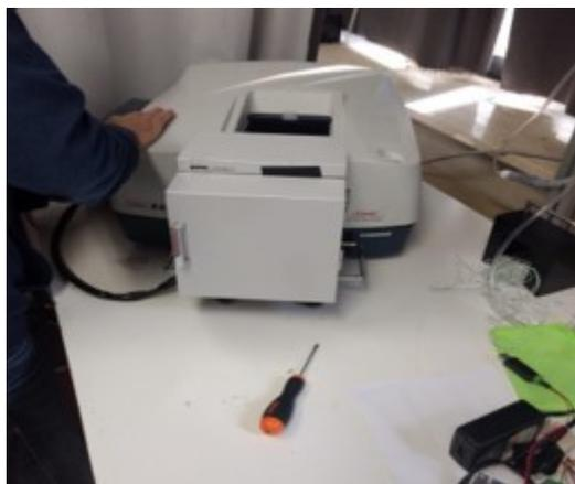
*Figura 22 – Spettrofotometro Jasco v670 per la riflessione*
