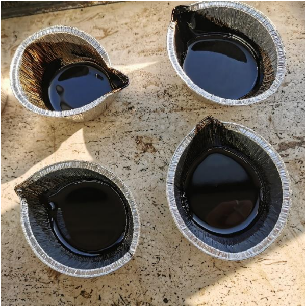
Figura 22 e 23: contenitori in alluminio, detti muffin, dove sono stati versati i bitumi invecchiati
