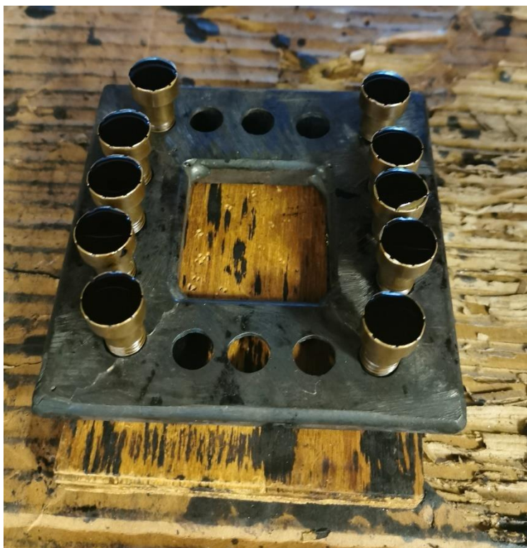
Figura 27: pull stub dopo essere stati in forno
