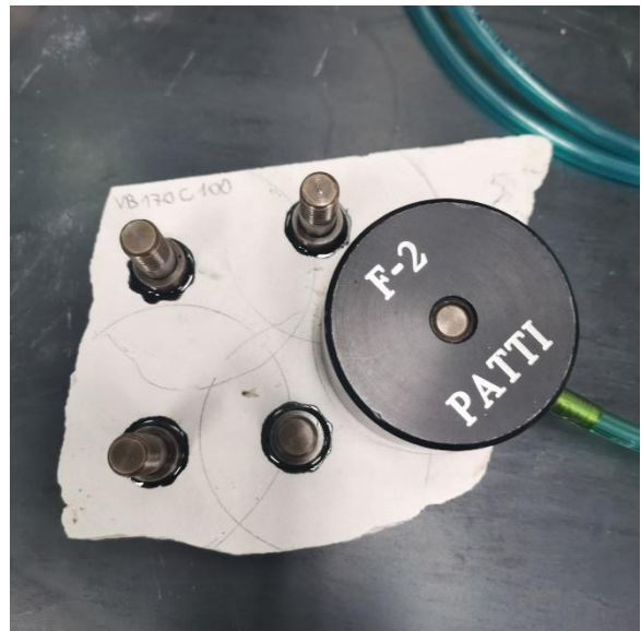
Figura 41 e 42: posizionamento corpo del pistone su pull stub e piatto al pistone
