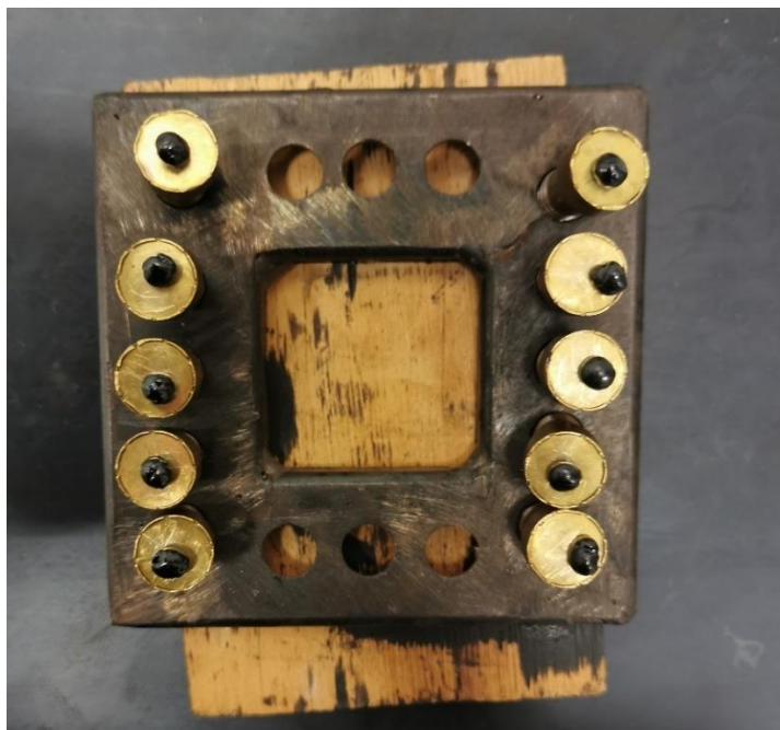
Figura 26: pull stub su supporto
