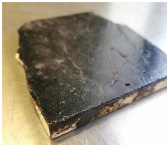
Figura 8 e 9: esempio di aggregato calcareo pre-bitumato
