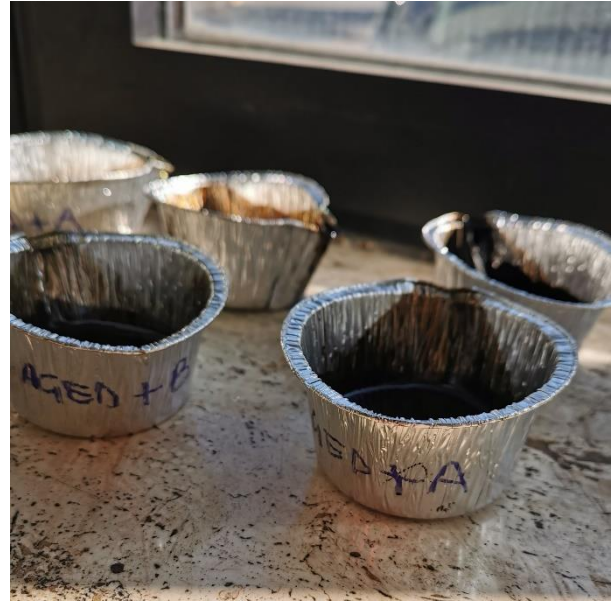
Figura 22 e 23: contenitori in alluminio, detti muffin, dove sono stati versati i bitumi invecchiati
