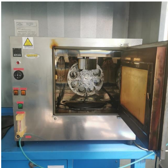
Figura 11 e 12: macchinario per la prova RTFOT
