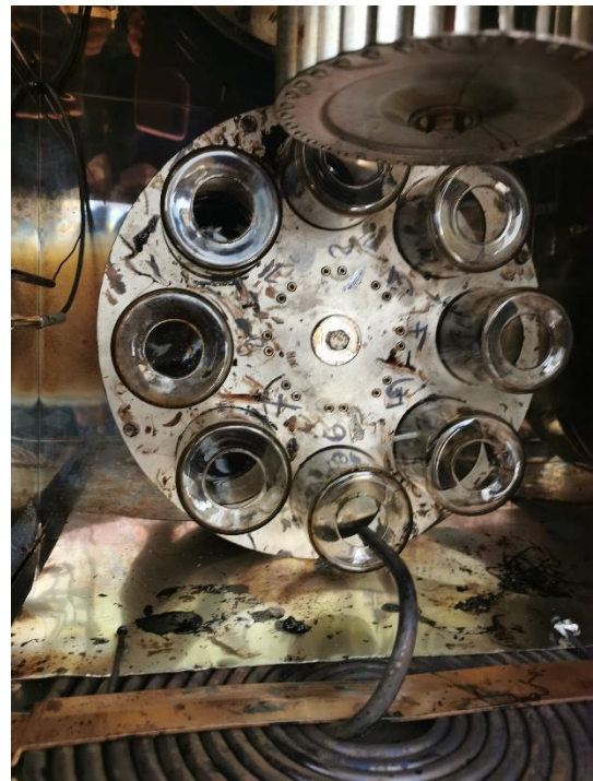
Figura 16 e 17: bicchieri collocati all'interno del supporto della macchina per la prova Rolling
