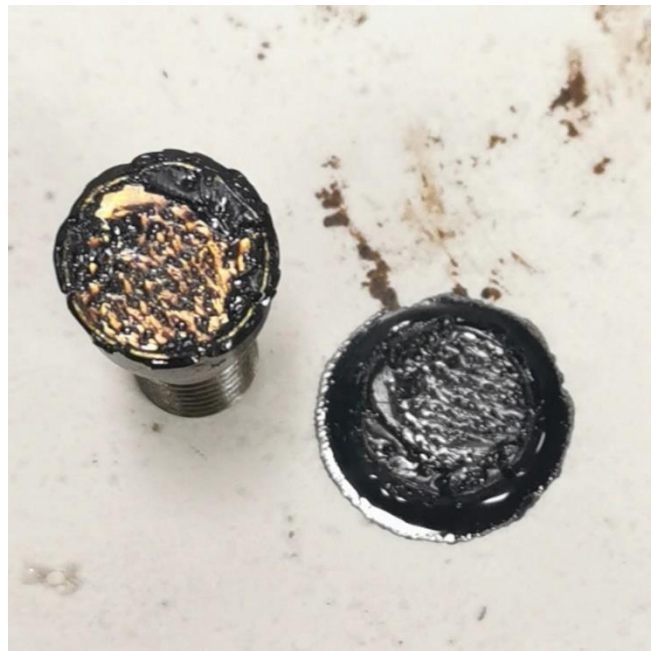
Figura 39: distacco del bitume
