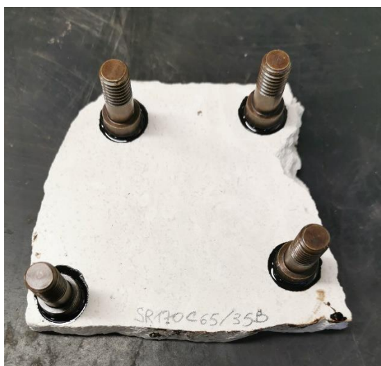
Figura 28 e 29: pull stub incollati sulle piastrine di calcare
