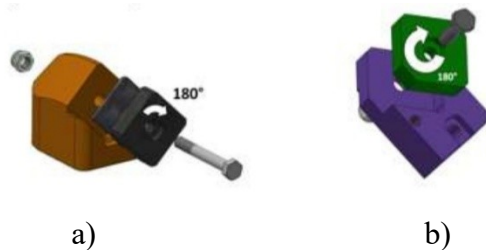
Fig.3.3 Lama(a) e contro lama(b) con supporti
