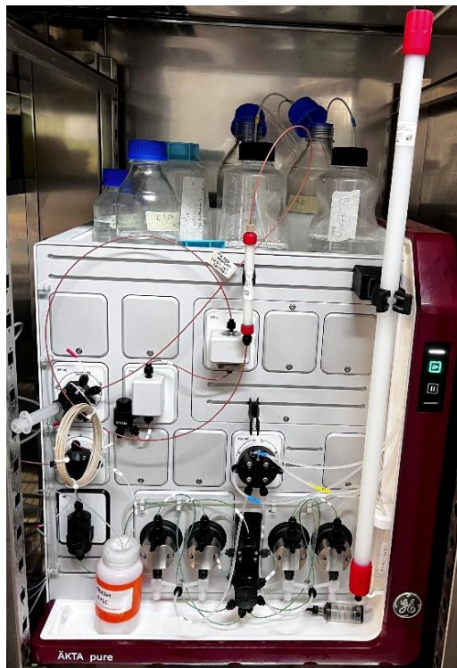
Figura 15. ÄKTA Pure FPLC con colonna a scambio anionico tenuto a 4 °C
