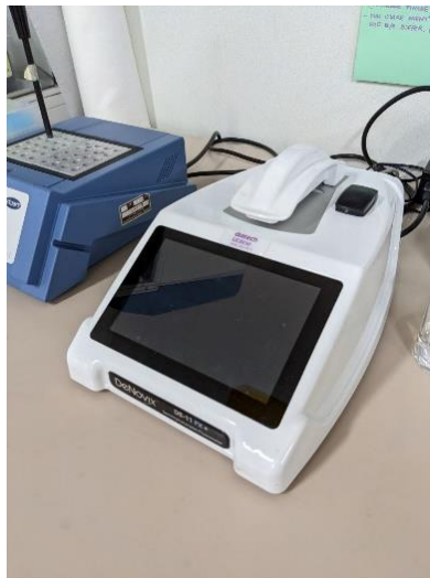
Figura 16. Nanodrop (DeNovix DS-11) utilizzato per quantificare la proteina attraverso metodi spettrofotometrici
