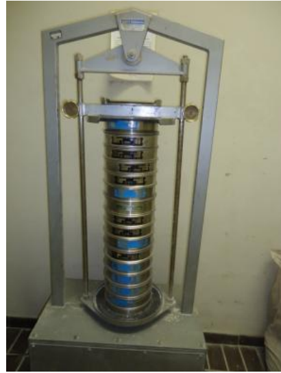
Figura 2.1.2.2 Colonna di setacci montata su vibrovaglio
