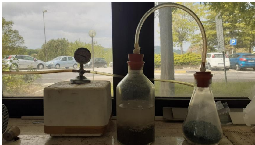
Figura 2.1.2.1 fase di estrazione dell'aria dal picnometro
