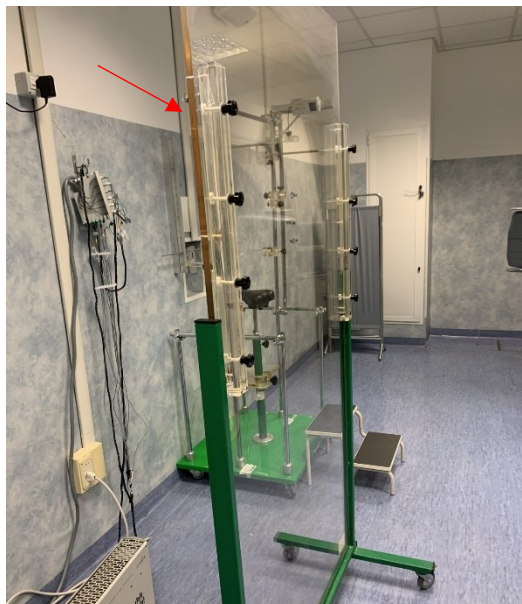
Fig. 6: spoiler in PMMA di 1,5cm
