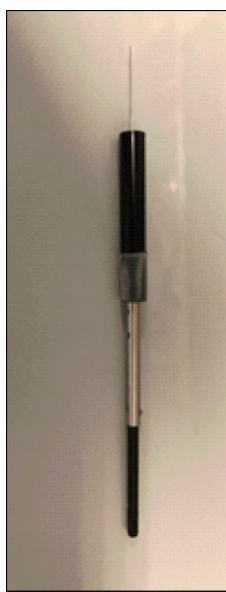
Fig. 10- fibra a tripla fase divinilbenzene/carboxen/polidimetilsilossano
