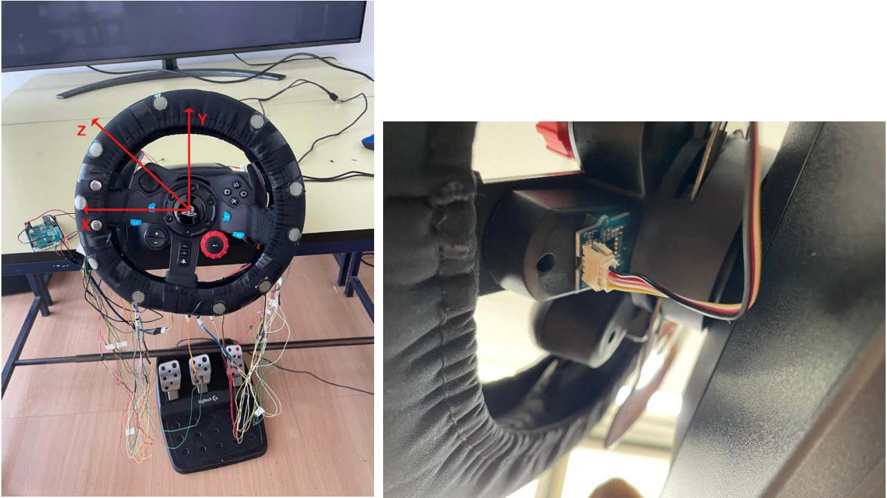
Figura 5 - Sistema di riferimento e posizionamento dell'accelerometro e giroscopio
