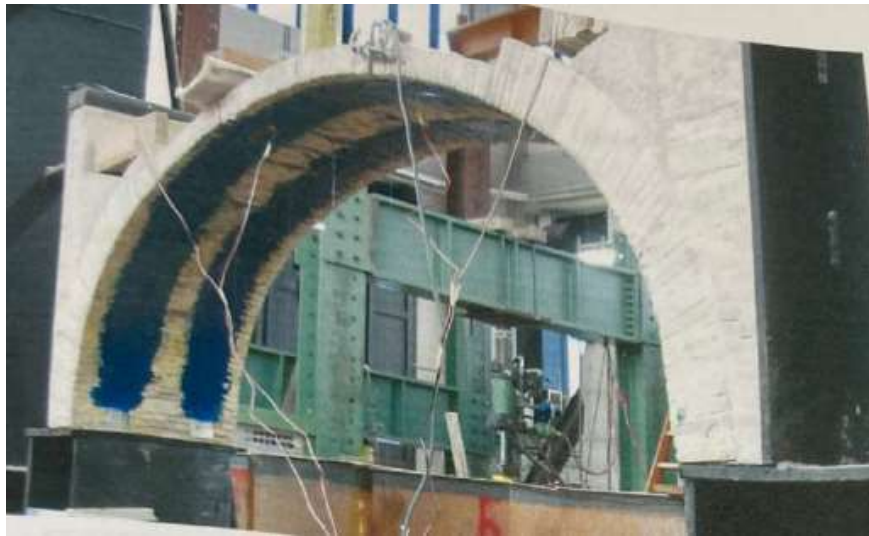
Figura 3.6 Arco rinforzato con BFRP
