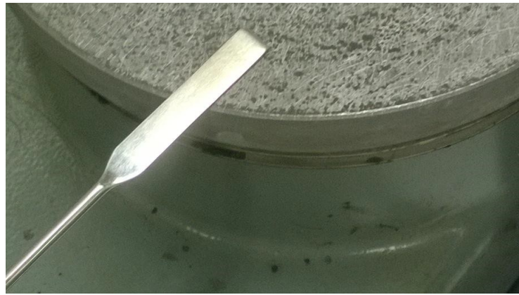
Figura 4.23 – Spatola sulla piastra riscaldata
