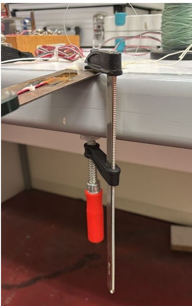
Figura 1- Incastro reale dato dall'ancoraggio con morsetto
