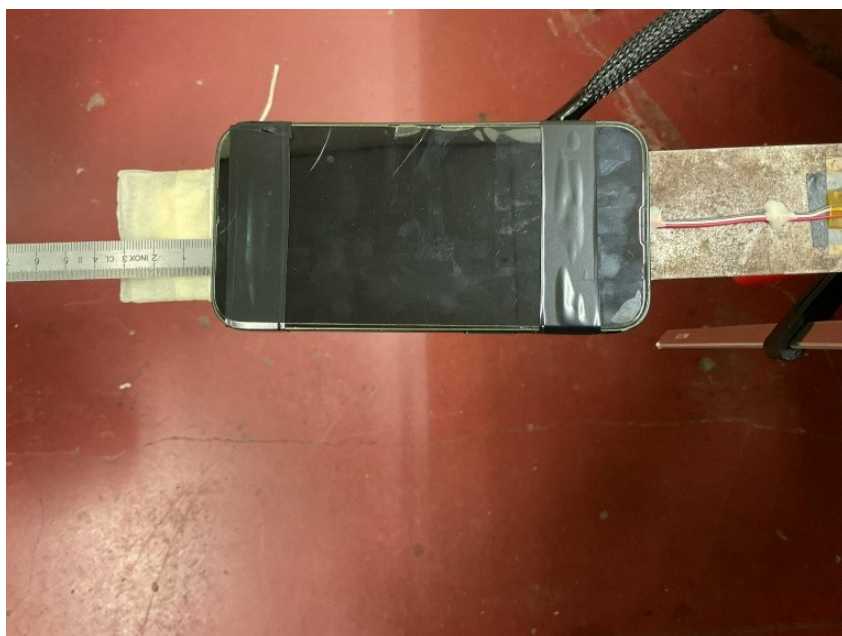
Figura 2 – Posizione smartphone su trave
