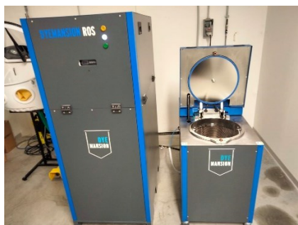
Figura 35: a sinistra è presente il macchinario destinato a produrre acqua distillata, sulla destra è presente la macchina destinata alla verniciatura.
