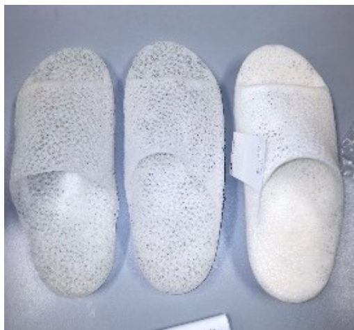
Figura 34: differenza tra i diversi trattamenti di lucidatura
