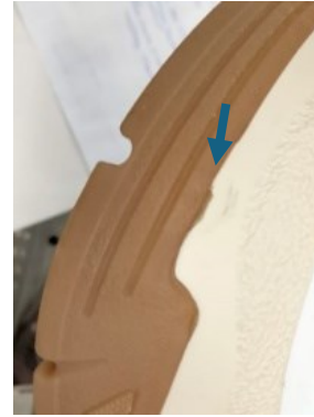
Figura 3: difetto per mancanza di materiale Figura 4: difetto per eccesso di materiale
