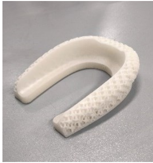
Figura 5: spoiler realizzato mediante stampante 3D
