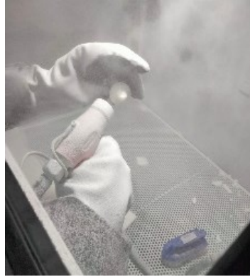
Figura 31: sabbiatrice manuale in funzione
