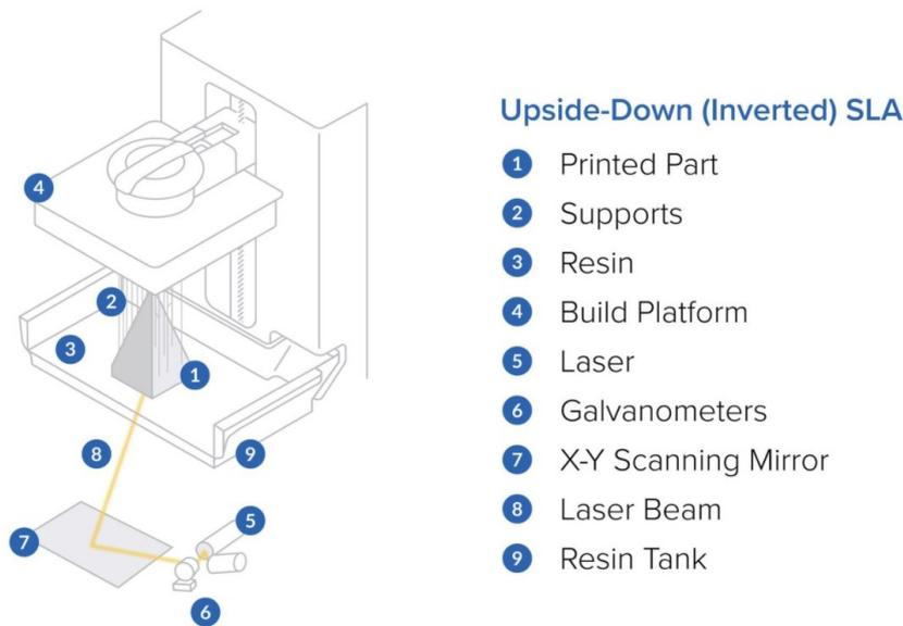
Figure 1.13: tecnologia di stampa SLA: notare il vassoio (9) su cui viene depositato il materiale: esso viene solidificato attraverso l'utilizzo di un fascio UV emesso dal galvanometro (6) e direzionato da uno specchio (7), tale che il primo layer si deposita sulla piattaforma di costruzione (4) che per facilitare l'adesione viene precedentemente riscaldata e che a seguito della formazione dei vari layer si sposterà verso l'alto [7]
