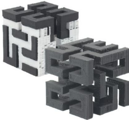
Figure 1.10: presa la tecnologia DIW o la FMD, esse possono realizzare manufatti piuttosto complessi attraverso l'utilizzo di inchiostri o filamenti di stampa solubili, si noti il seguente esempio: nella figura più a sx, in bianco, sono visibili i supporti solubili; la figura più a dx, mostra il prodotto finito dopo la rimozione dei supporti solubili. Analogamente avviene per i metamateriali [6]
