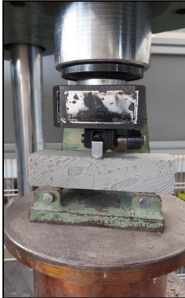
Figura 11: Provino sottoposto a prova a flessione
