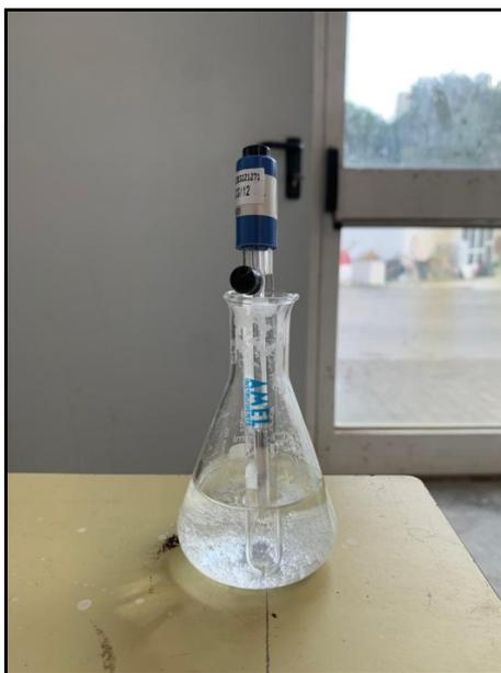
Figura 33: elettrodo SCE
