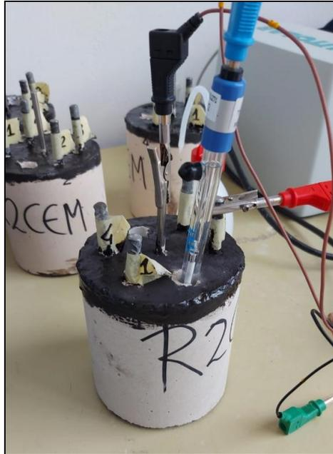
Figura 44: Misurazioni del potenziale in asciutto
