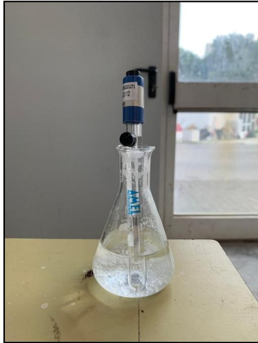
*Figura 22: Elettrodo SCE di riferimento*
