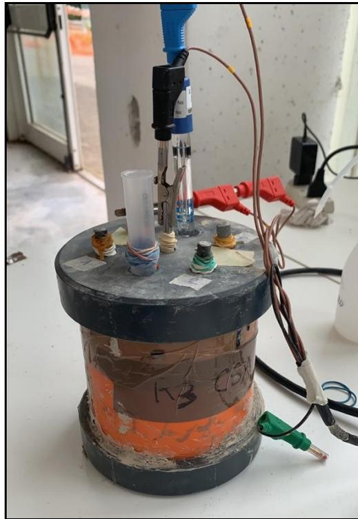
Figura 32: Strumentazione utilizzata per le prove di corrosione e collegamenti con il provino da testare.
