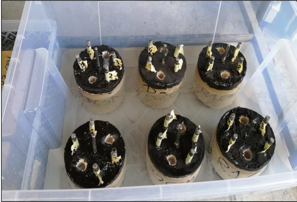
Figura 46: Provini in soluzione acquosa al 3,5% di NaCl
