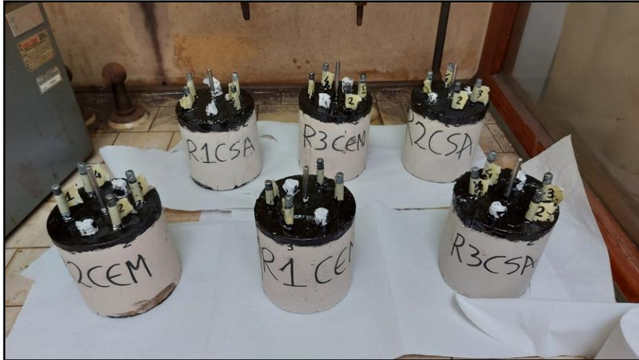
Figura 43: Provini dopo la resinatura
