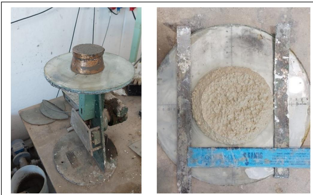
Figura 8: Tavola a scosse e misurazione successiva dello spandimento
