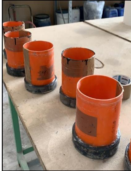
*Figura 20: Casseri dei provini cilindrici*
