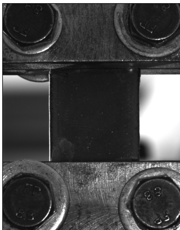
Figura 31: Inizio rottura smalto PG2
