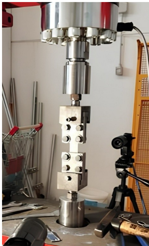
Figura 18: Montaggio blocco su morse macchina
