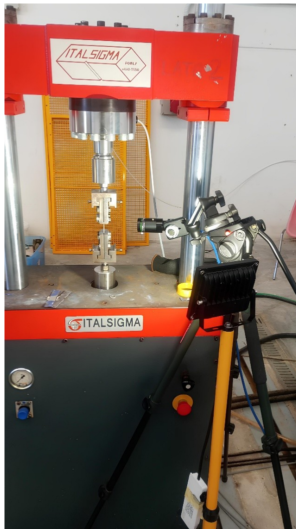
Figura 22: Allestimento banco prova a fatica
