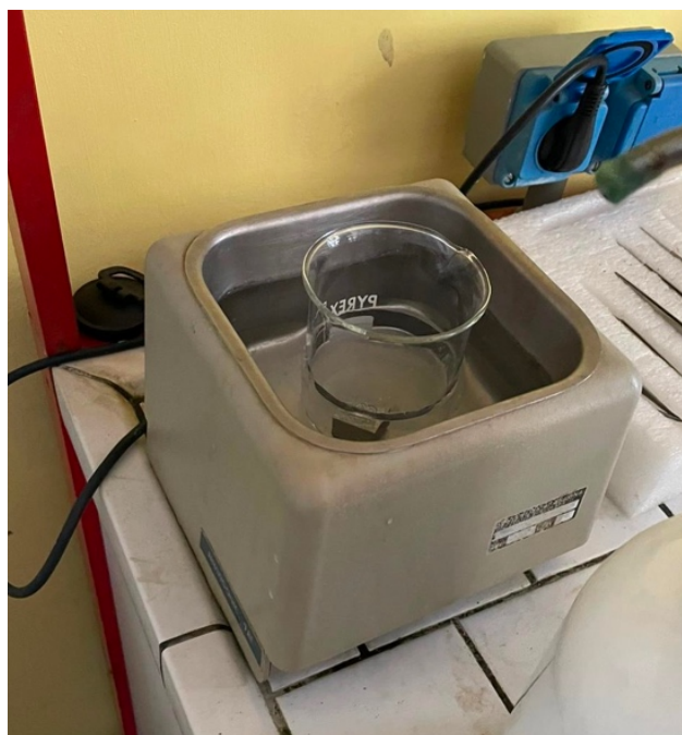
Figura 3.2 Vasca a ultrasuoni del laboratorio in funzione.
