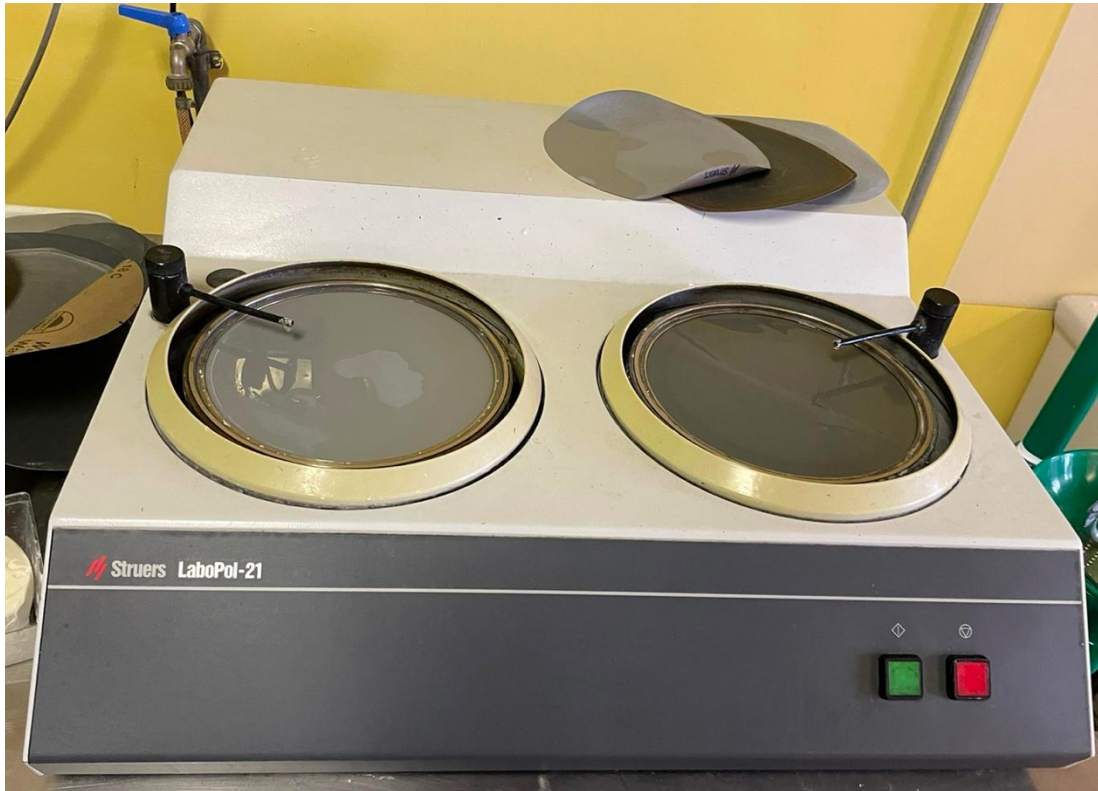
Figura 3.3 Smerigliatrice a carta abrasiva del laboratorio
