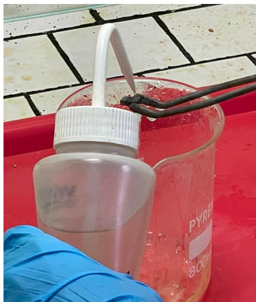
Figura 3.8 Attacco chimico sul provino “as build”
