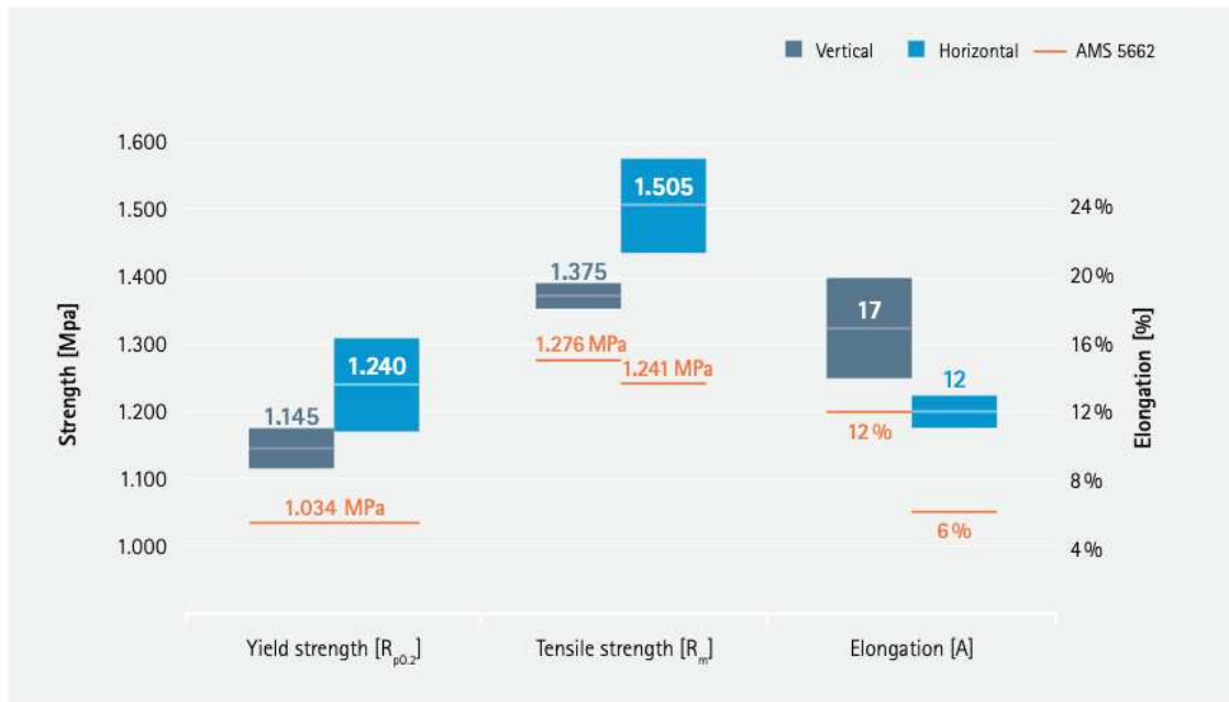
Figura 2.5 Proprietà meccaniche di un provino in INCONEL 718 realizzato tramite AM. (Fonte: [18])
