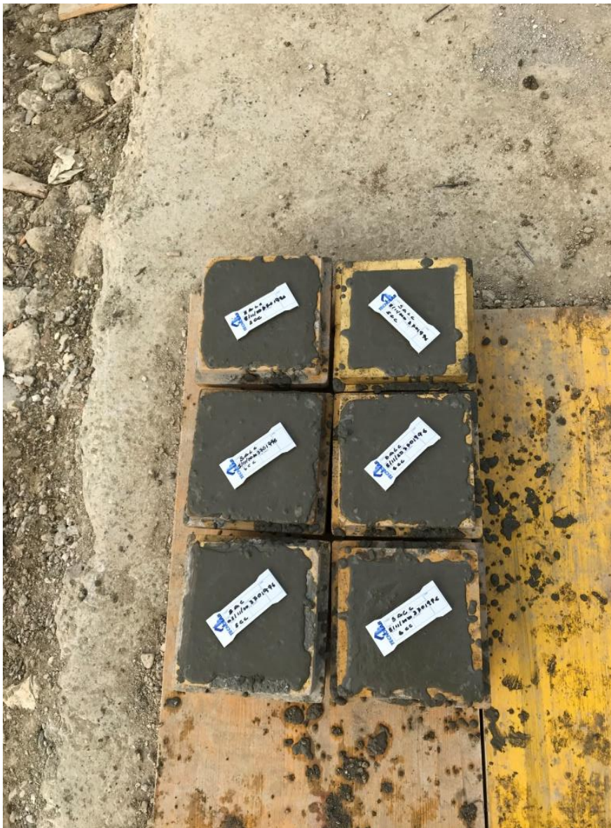
Figura 5.7.1. Confezionamento dei provini in cantiere
