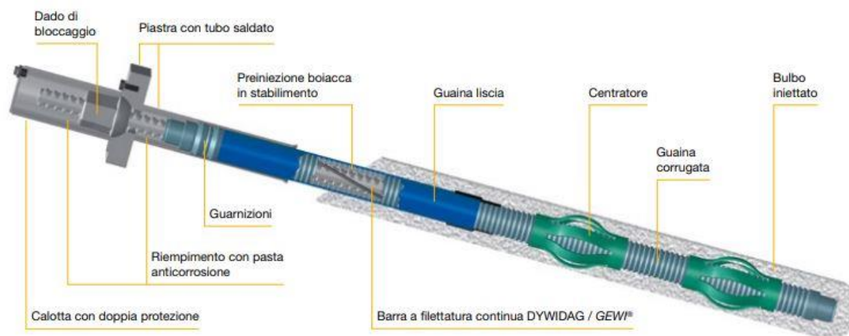
Figura 3.3. Tirante a barre DYWIDAG a filettatura continua
