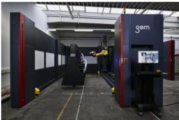
Figura 2: Macchina di misura a coordinate ottica 3D ATOS ScanBox 7260 per pezzi di grandi
