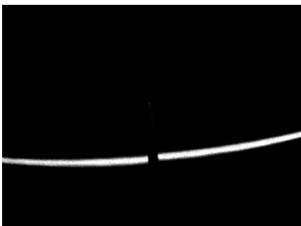
Figura 24: Gap 3 mm e Flush 1 mm
