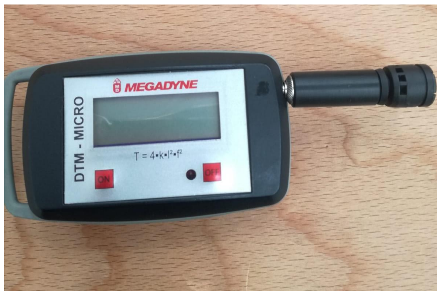
Fig.5.6 Fonometro utilizzato per le misure di frequenza naturale della cinghia
