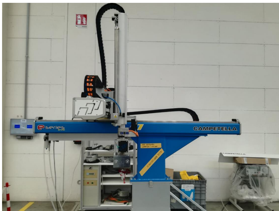
Fig.5.2 Immagine del CR, fissato al banco di collaudo per esecuzione test
