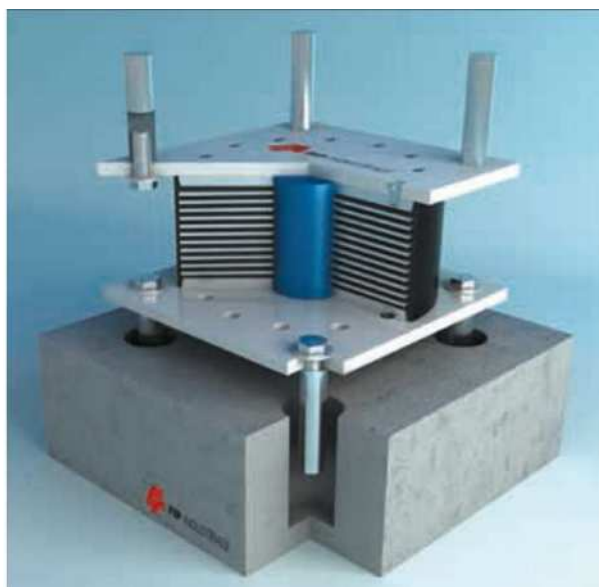
Fig. 3.16 _Isolatori elastomerici con nucleo in piombo centrale, (FIPMEC).
