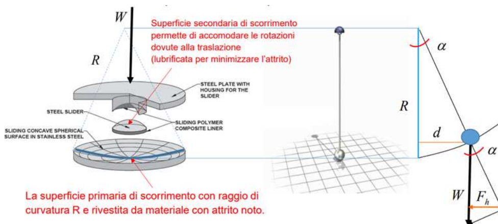
Fig. 3.23_Isolatore a scorrimento
