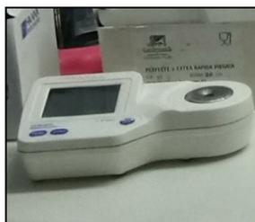
**Figura 6.** Rifrattometro digitale "HI-96801" 0-85% Brix", usato per determinare la concentrazione zuccherina.
