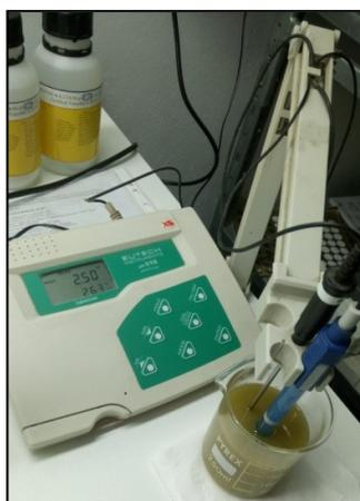
**Figura 7.** pHmetro "CyberScan 510 - Eutech Instruments" per misurare il pH dei mosti.
