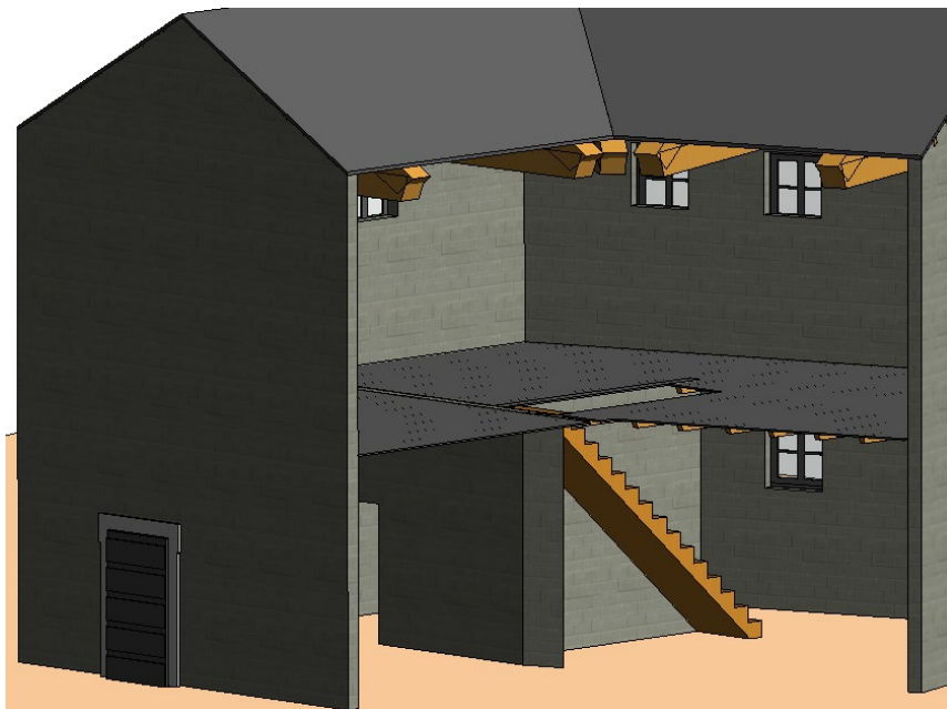
Figura 3.5.2 – Spaccato dell'interno della caserma nel Rivellino (1732)
