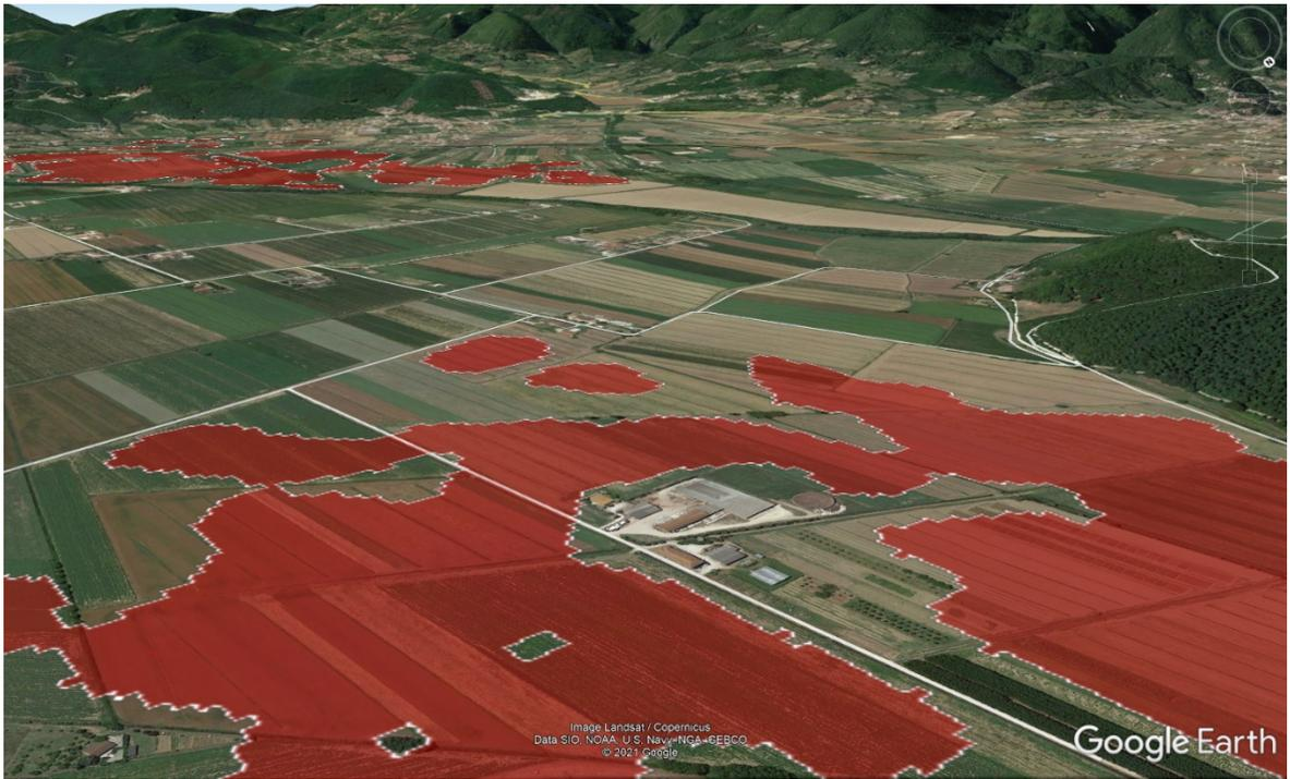
Figura 32 Confronto in dettaglio tra foto aeree in-situ e maschera dell'inondazione ricavata con Metodo Minimo
