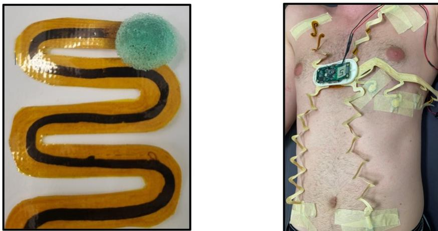
Figura 4.1. Spugnetta innestata sull'elettrodo ed apparato posizionato sull'utente
