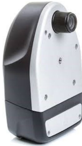
Figura 3.1 - Telecamera Senop HSC-2, utilizzata per l'acquisizione ed elaborazione dei dati.
