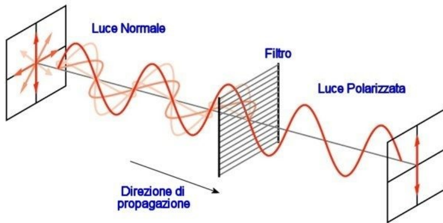
Figura 2.2 – Rappresentazione del funzionamento di un filtro ottico.
