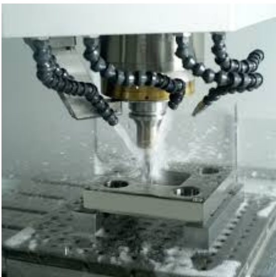
Fig.5.3.1- Fresatura ad alta velocità(HSM)
