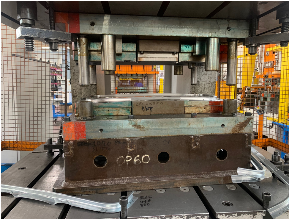
Fig.7.1- Stampo ReteMidrange- Ferrari GTC4 Lusso
